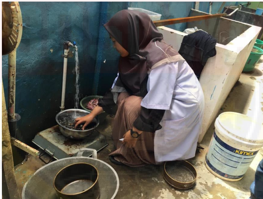
MEMBERSIHKAN MATERIAL UNTUK UJI LOLOS SARINGAN NO.200
