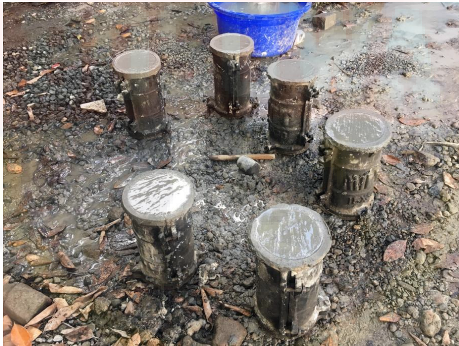
PEMBUATAN BENDA UJI (BETON NORMAL)
