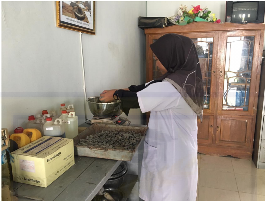
MENIMBANG AGREGAT KASAR UNTUK UJI ANALISA SARINGAN
