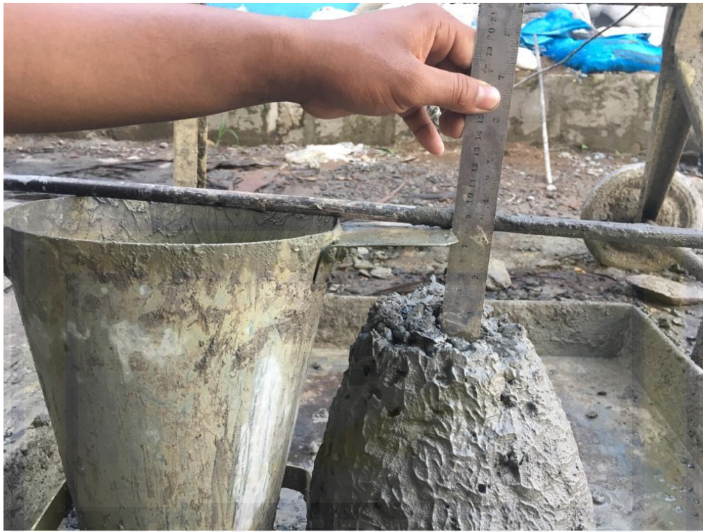
PENGUKURAN SLUMP BENDA UJI
