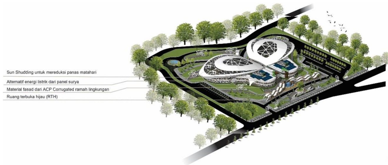
GAMBAR 9 Struktur Bangunan Utama dan Material Elemen Fasad
