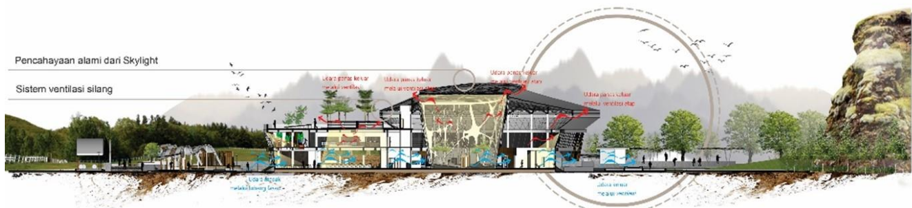
GAMBAR 7 Skema Penghawaan dan Pencahayaann Alami Pada Bangunan
