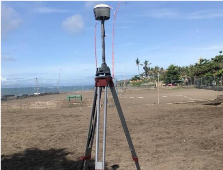
Gambar 5: (atas) Marker GCP dan (bawah) ICP dan RTK-GNSS Trimble R8s.
