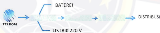
Gambar 4.26: Tahapan Instalasi Komunikasi
