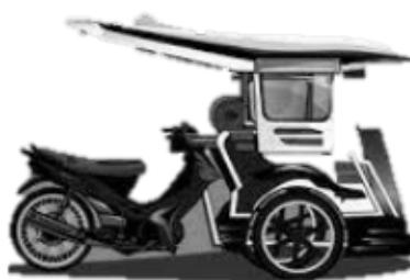
Bentor is a modified motorcycle with a rear seat for passenger transport. (*Bentor adalah sepeda motor yang telah dimodifikasi dengan tambahan kursi belakang untuk mengangkut penumpang*) This transportation model is commonly found
