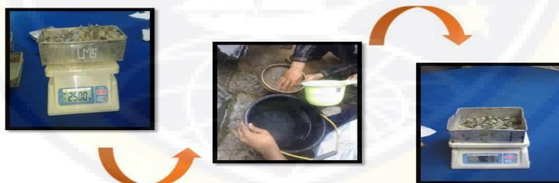
Gambar 2.3 Pemeriksaan Kadar Lumpur Agregat Kasar
