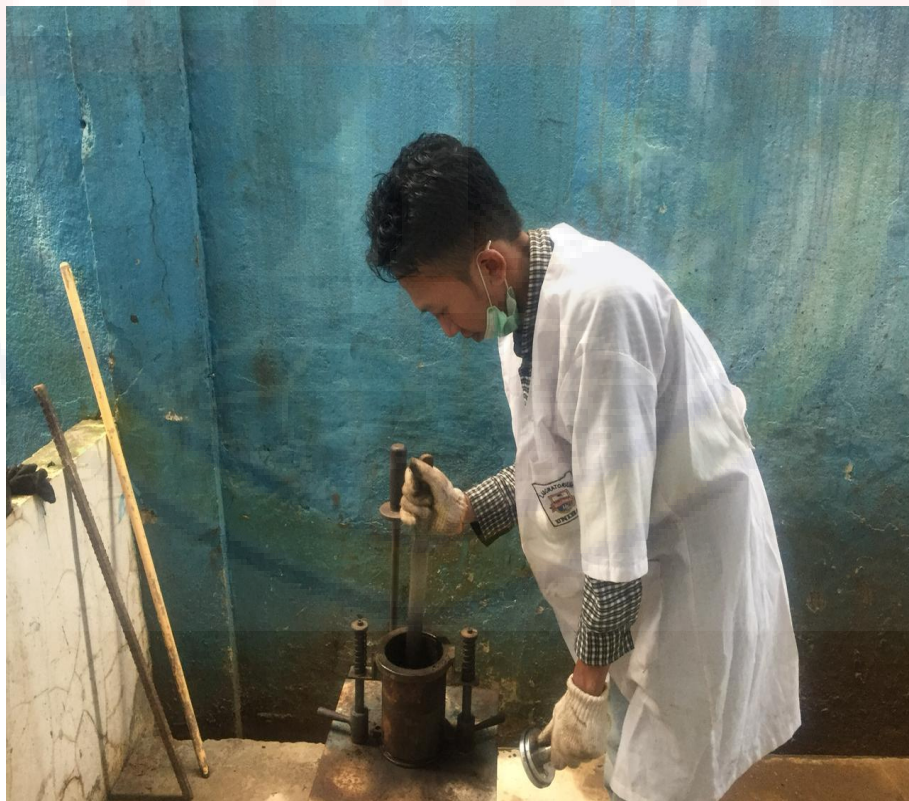
Proses meratakan material dan aspal menggunakan spatula
