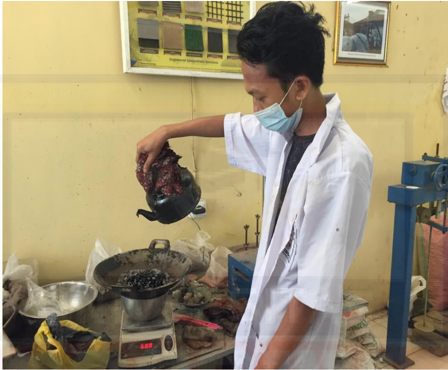
Penambahn aspal Pada material
