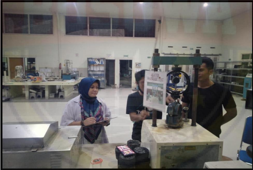
**Gambar 8** Pengujian Marshall
