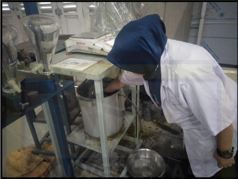
**Gambar 5.** Proses Penimbangan Dalam Air
