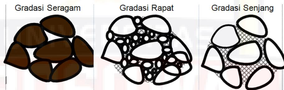
**Gambar 2.6. Ilustrasi Gradasi Agregat**
