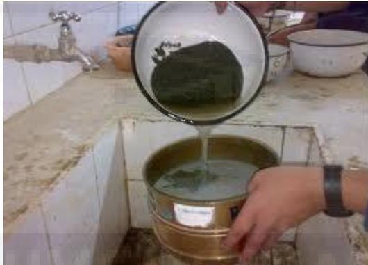
**Gambar 3.6. Pengujian kadar lumpur**
