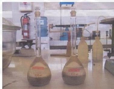
**Gambar 3.5. Pengujian Berat Jenis Agregat Halus**
