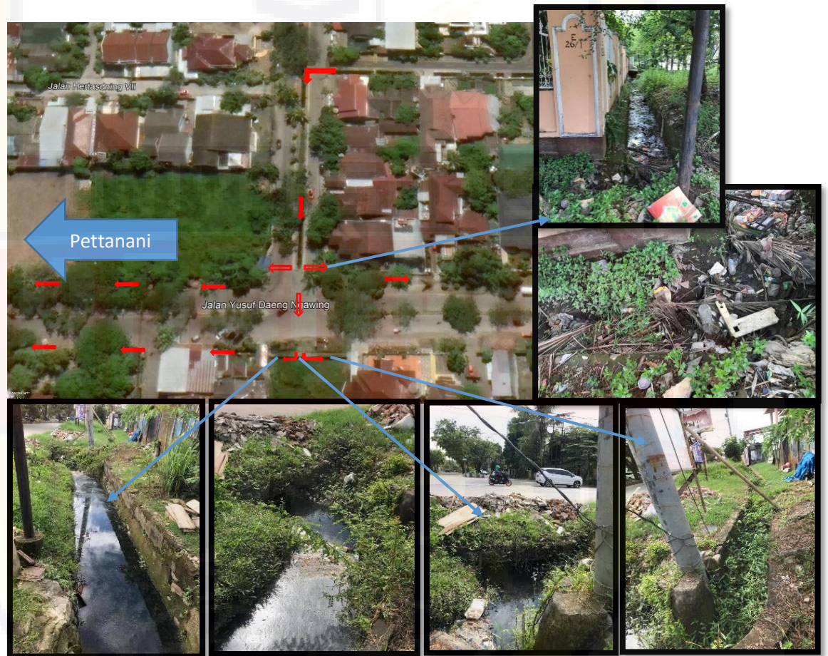
Gambar 4.13 Detail titik penyumbatan saluran Zona A
