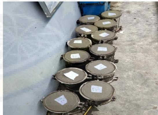
**Hasil perncampuran agregat beton variasi**
