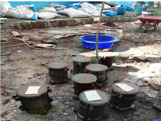
**Proses mencetak beton menggunakan silinder tabung 15x30**
