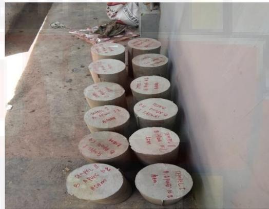
**Hasil pembongkaran beton dari silinder**
