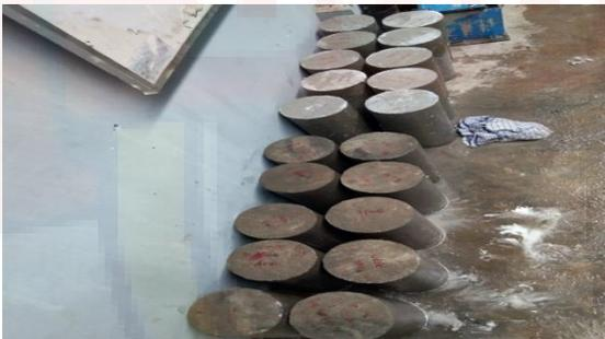
**Proses pengangkatan beton setelah proses perendaman**
