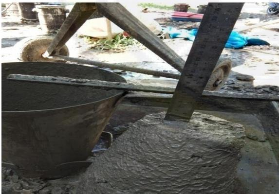
**Pengujian slump test**
