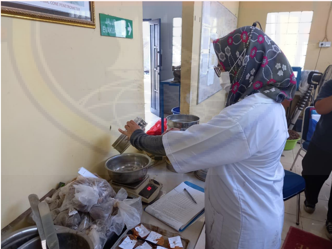
Proses Penimbangan Analisa Saringan
