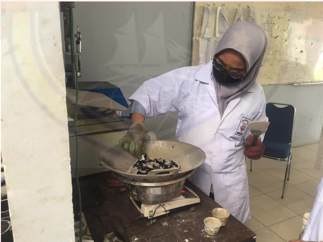
Proses Penimbangan Kadar Aspal Cair
