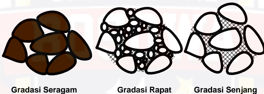
Gambar 2.7. Ilustrasi Gradasi Agregat (sumber : BALITBANG-PU, modul TOT 2007)
