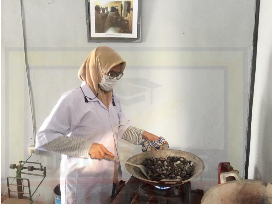
Proses Pencampuran Aspal Cair dan Agregat
