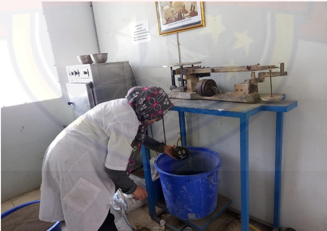
Proses Penimbangan Sampel Dalam Air
