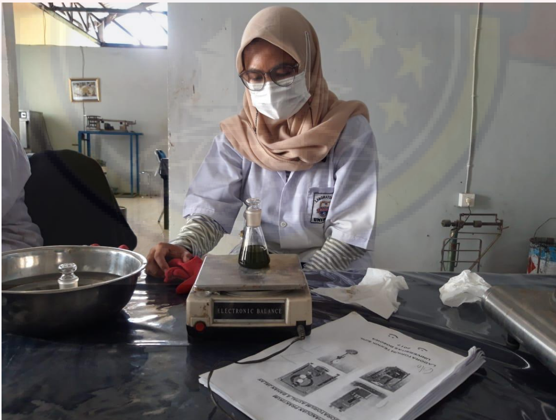
Proses Pengujian Berat Jenis Aspal
