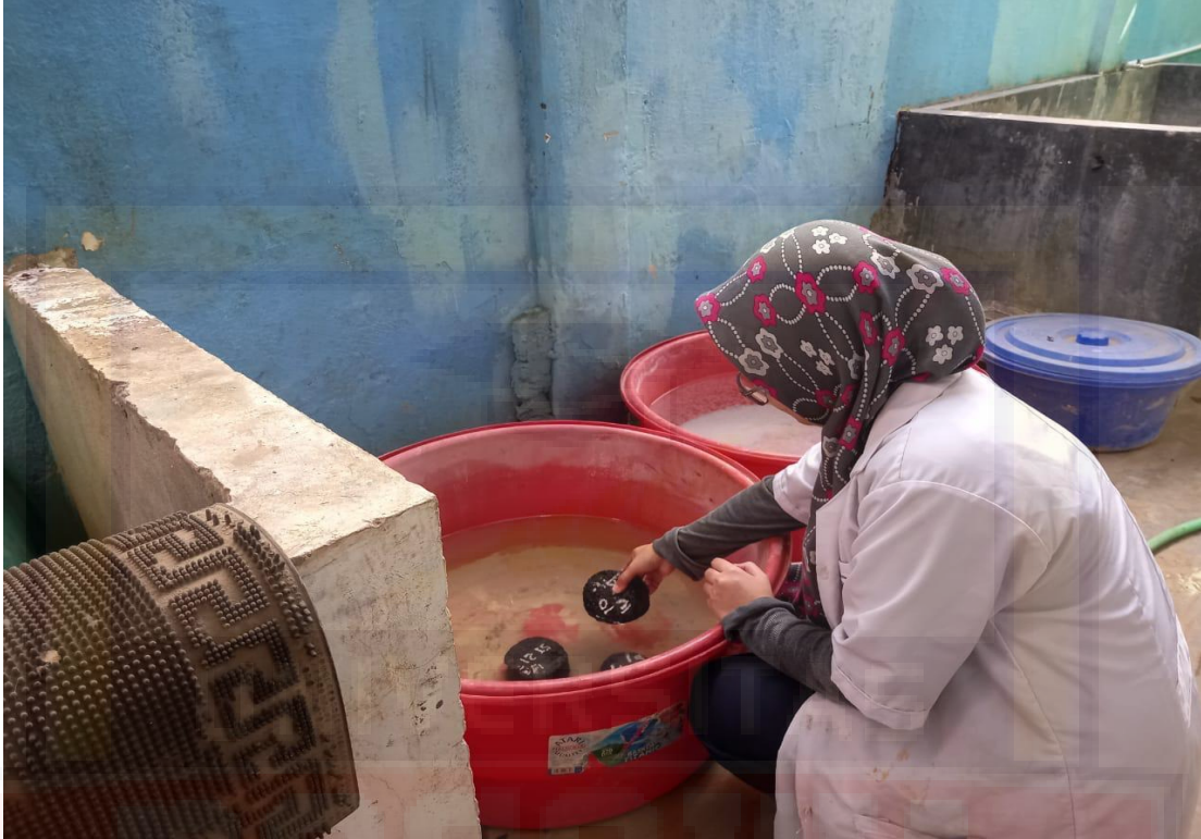
Proses Perendaman Berulang Sampel Variasi
