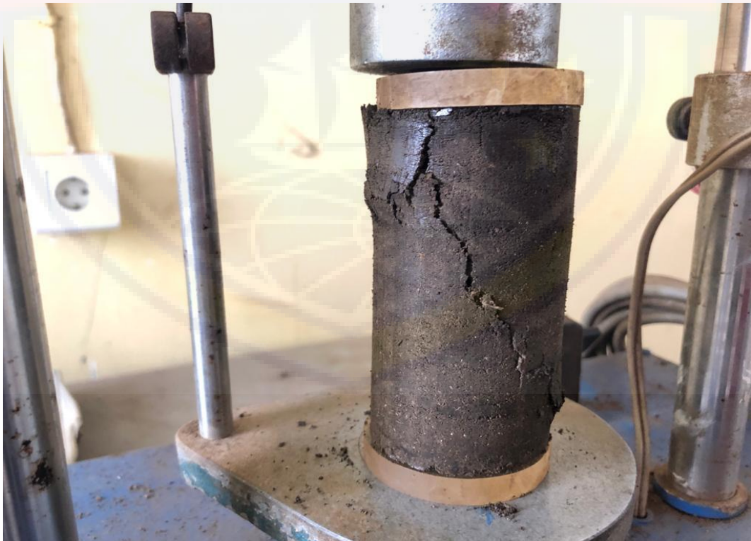
RETKAN YANG TERJADI PADA PENGUJIAN
