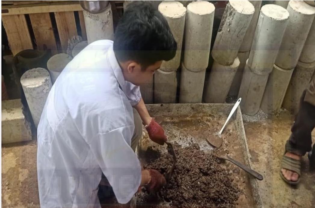
PROSES MIX DESAIN YANG DILAKUKAN SECARA MANUAL
