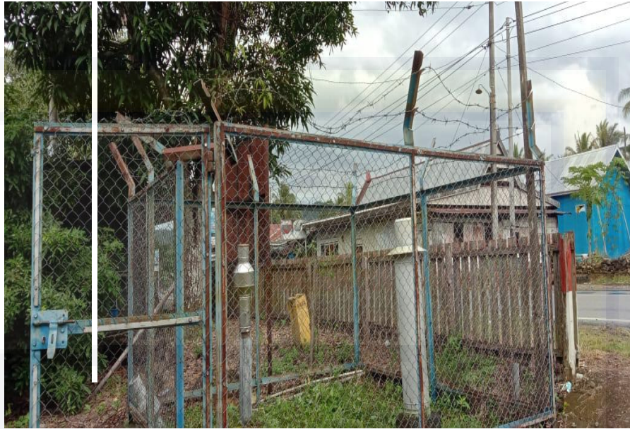
Gambar 7. Alat ukur curah hujan di stasiun Bancee
