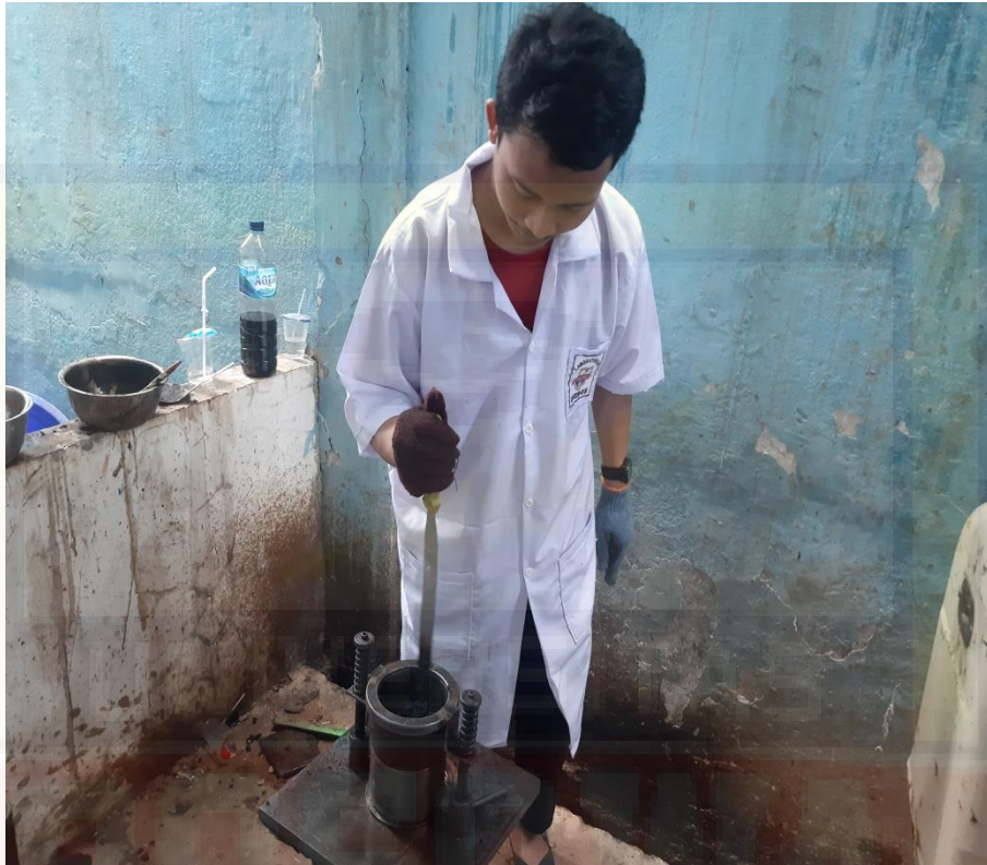
Proses meratakan material dan aspal menggunakan spatula
