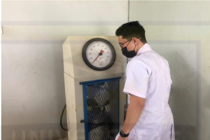
Proses Pengujian Kuat Tarik Belah
