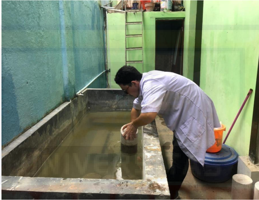
Proses Perendaman Beton Selama 28 Hari
