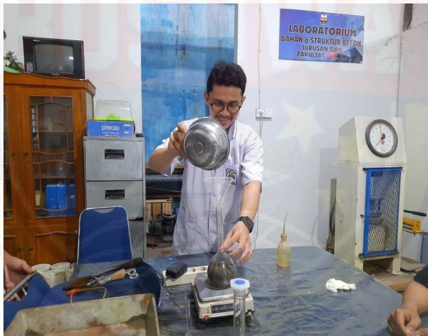
Penimbangan Agregat Halus Untuk Pengujian Kadar Air
