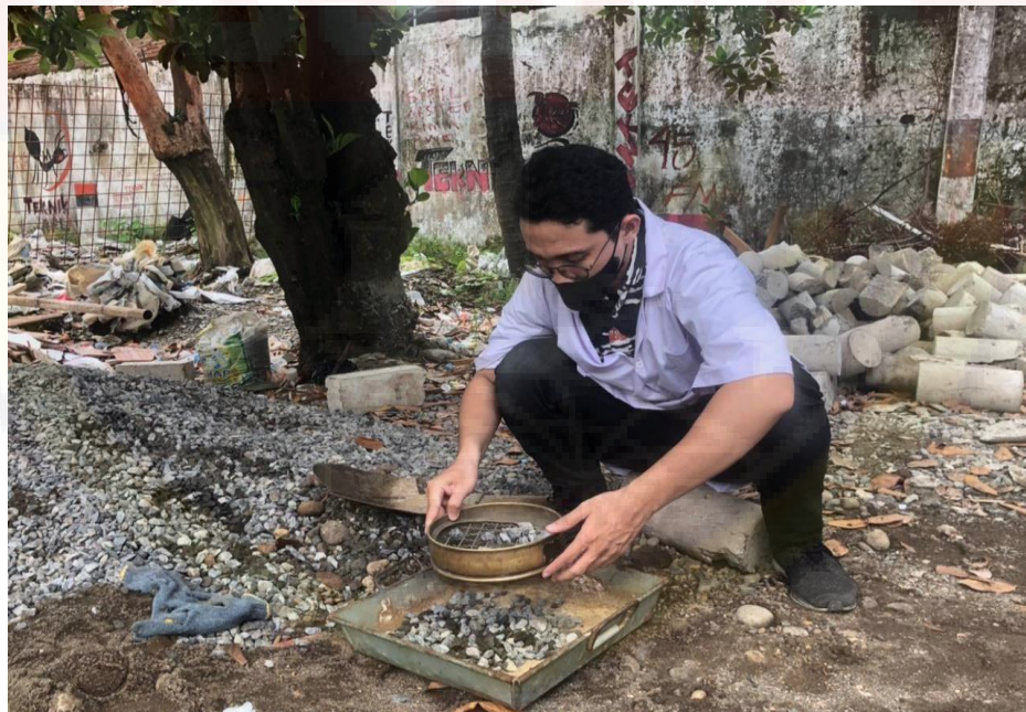
Proses Penyaringan Agregat Kasar Menggunakan Saringan \frac{3}{4}
