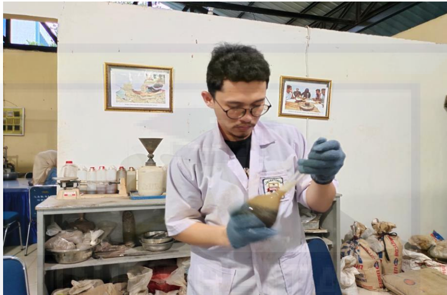
Pengujian Berat Jenis Agregat Halus
