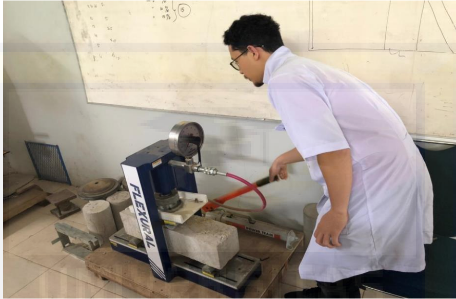
Proses Pengujian Kuat Lentur
