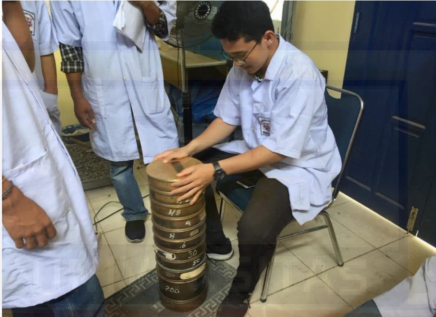
Pengujian Analisa Saringan
