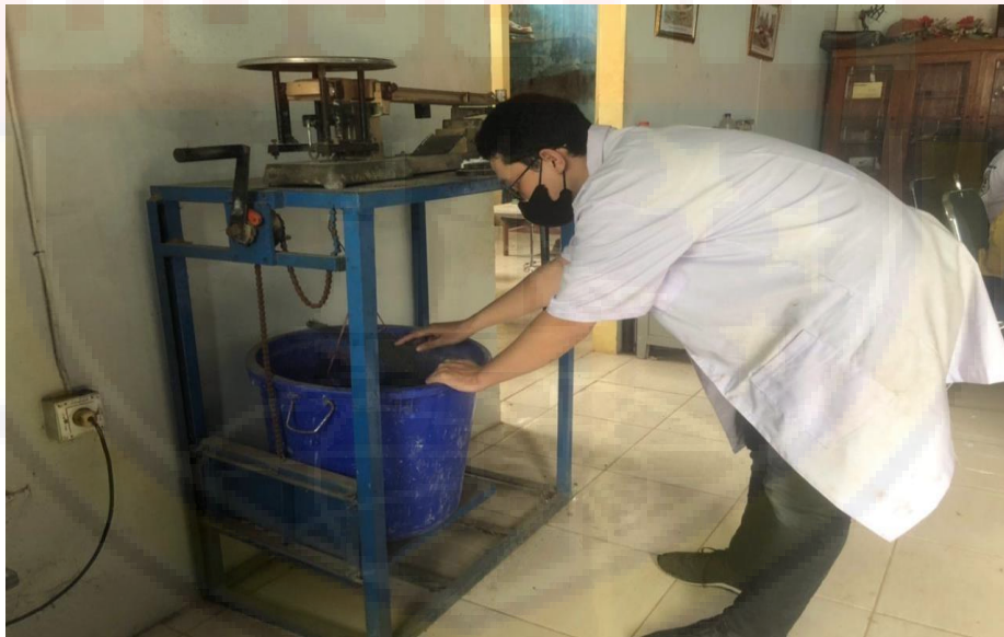
Pengujian Berat Jenis Agregat Kasar
