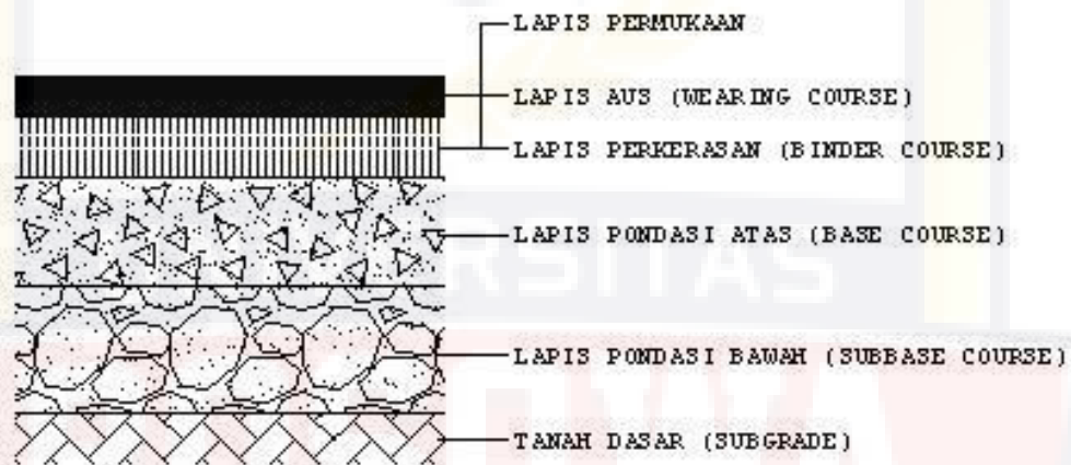
Gambar 2.2 Komponen Perkerasan lentur
