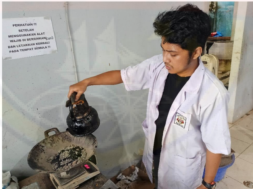
Proses Penuangan Aspal Pada Campuran Agregat
