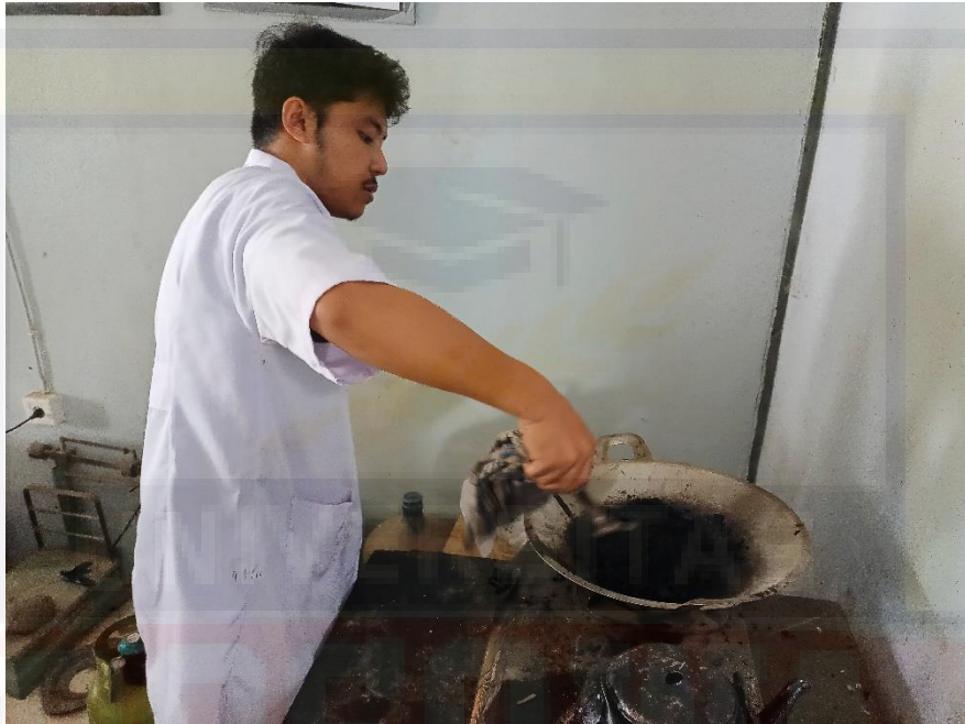
Proses Pencampuran Agregat , Filler Dan Aspal ( Hot Mix )
