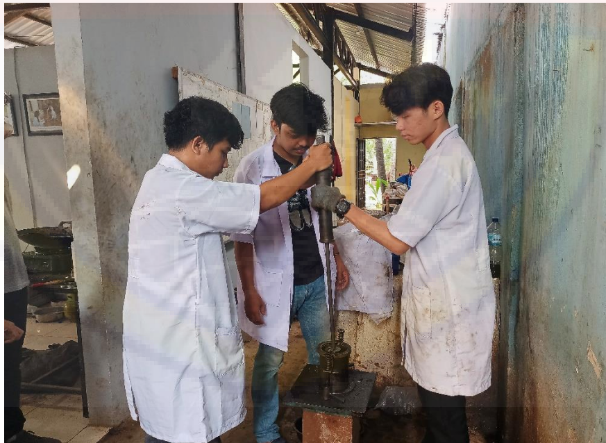
Proses Pembuatan Briket Dengan Alat Penumbuk
