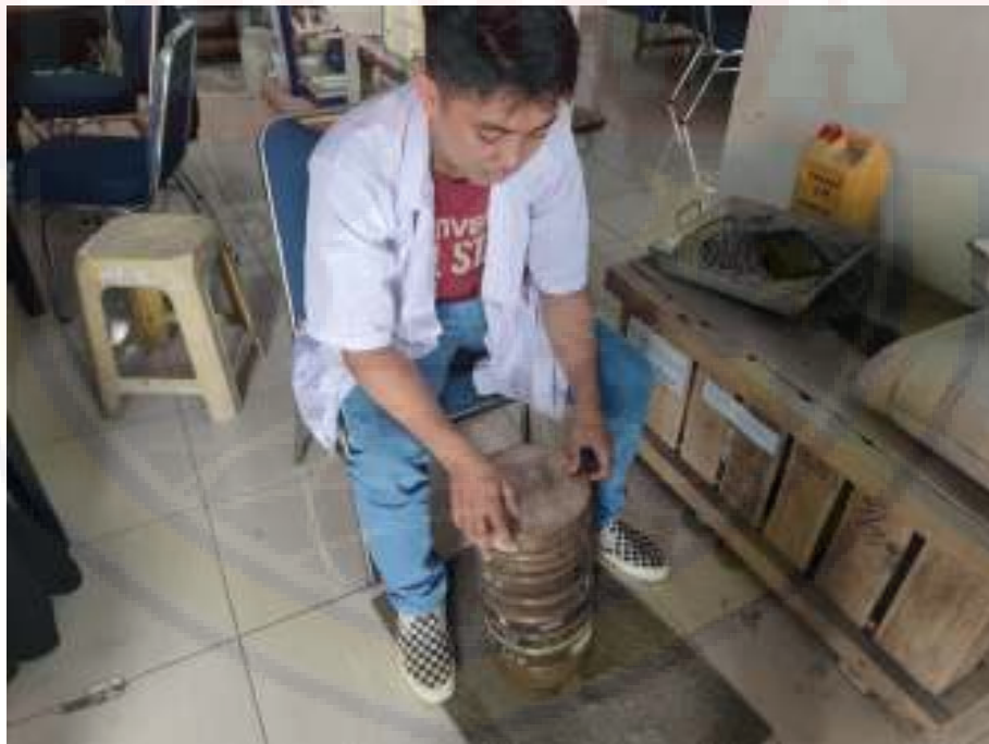
Analisa saringan agregat kasar dan halus
