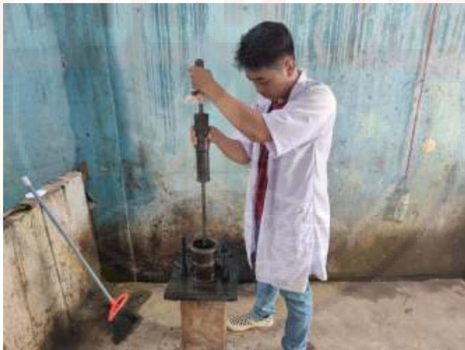
Pembuatan benda uji dengan 75 kali tumbukan setiap sisi
