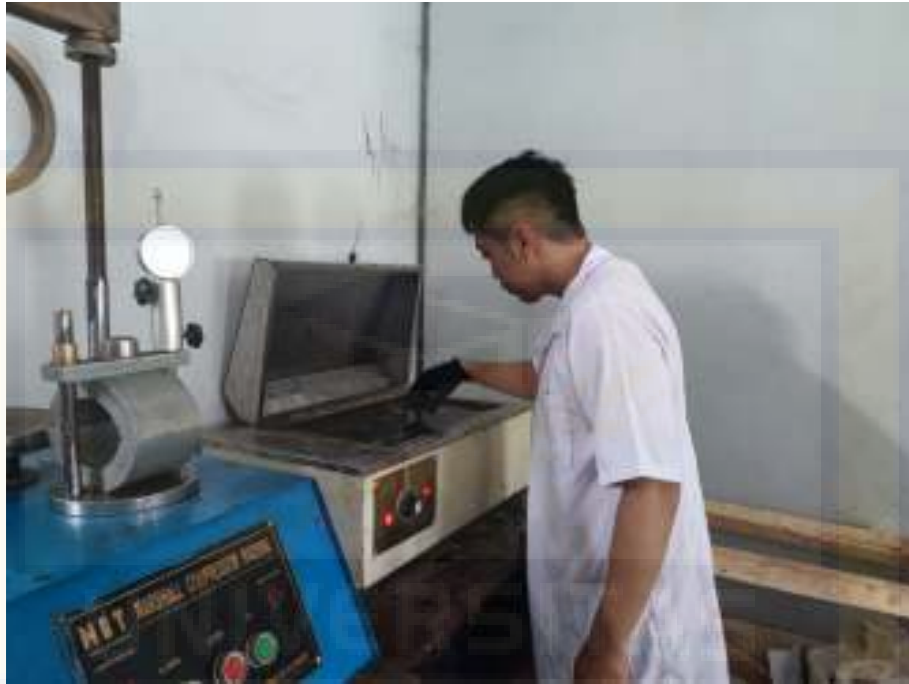
Perendaman di waterbath selama 30 menit dengan suhu 60°C
