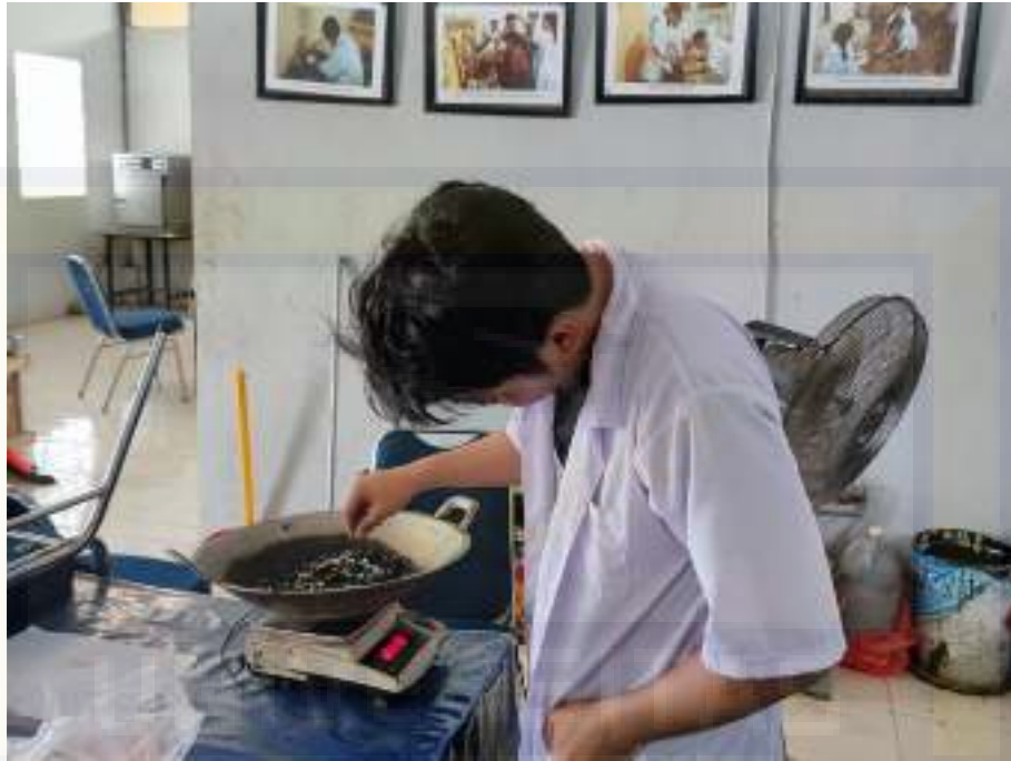
Proses pencampuran CPHMA dengan HDPE
