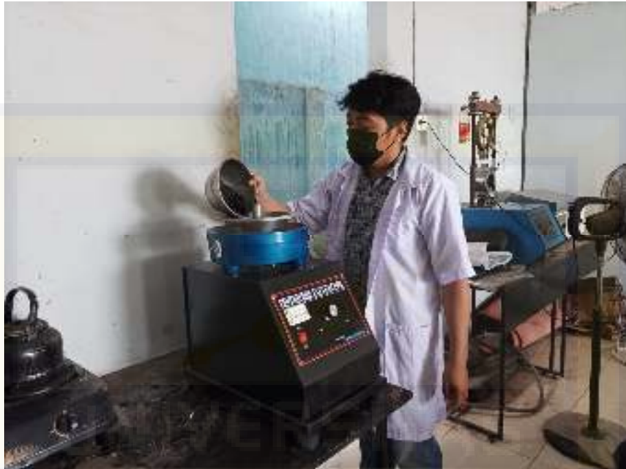
Pemeriksaan kadar aspal menggunakan mesin ekstraksi
