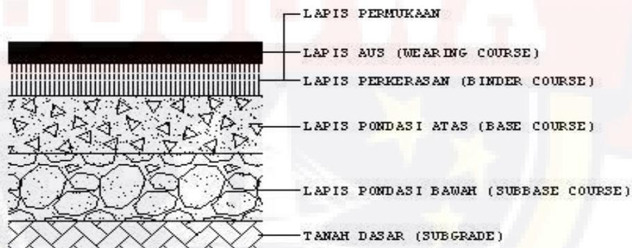
Gambar 2.2.Susunan Lapis Perkerasan Lentur (*Flexible Pavement*)
