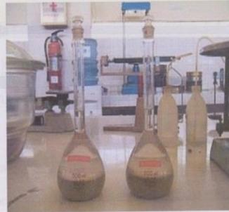
**Gambar 3.4. Pengujian Berat Jenis Agregat Halus**
