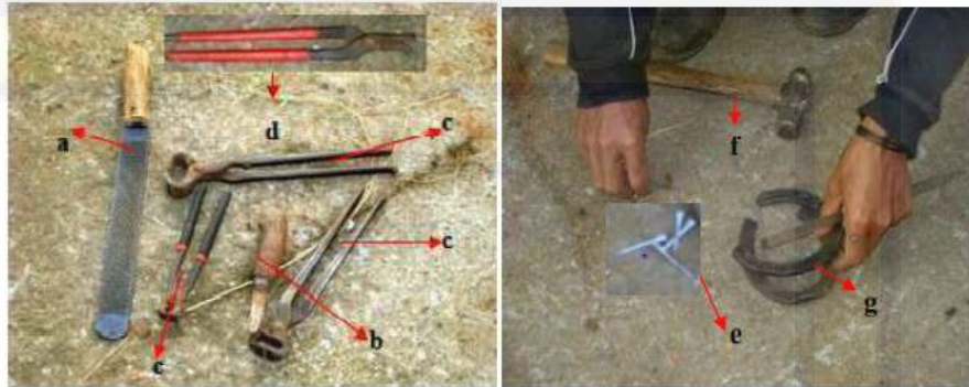
Gambar II. 11 Alat-alat Pemasangan Tapal Kuda (a) Kikir, (b) Pisau, (c) Gegep, (d) Gegep Buaya, (e) paku khusus tapal, (f) paku dan (g) tapal Sumber : https://www.decathlon.co.id/in/perengkapan-berkuda
