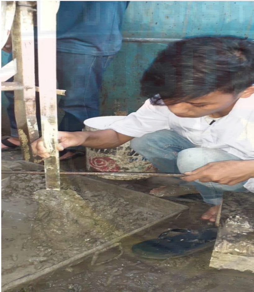
Pengujian Slump Test
