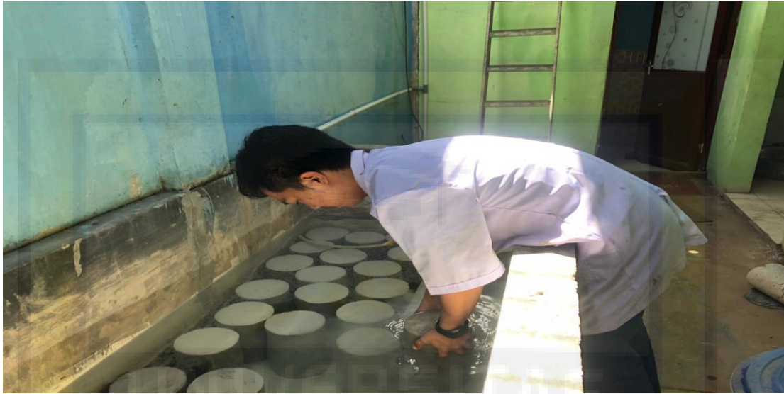
Proses Perendaman Beton Selama 28 Hari
