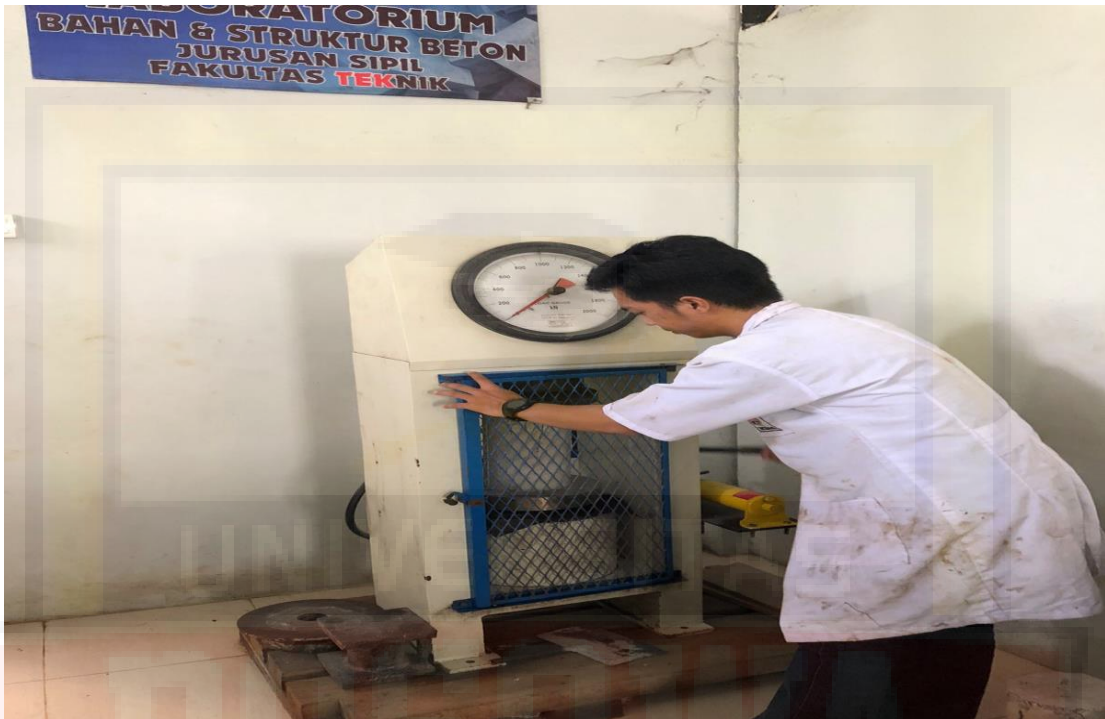
Proses Pengujian Kuat Tekan Beton
