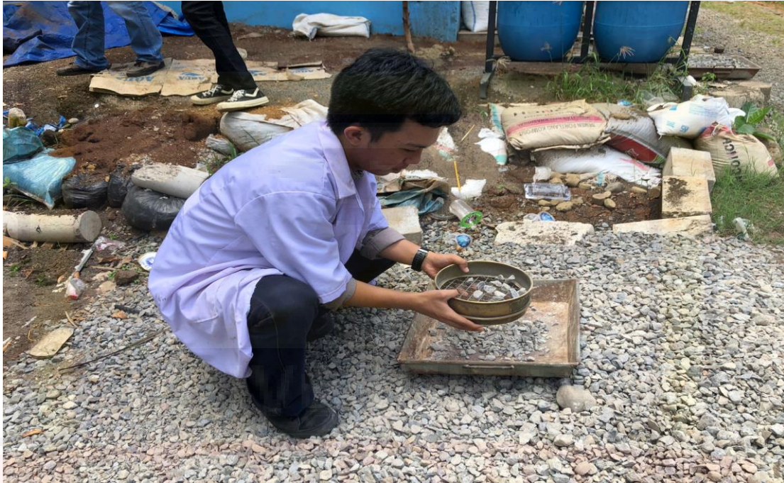
Proses Penyaringan Agregat Kasar Menggunakan Saringan \frac{3}{4}
