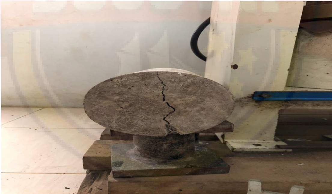
Beton Setelah Di Uji Kuat Tarik Belah
