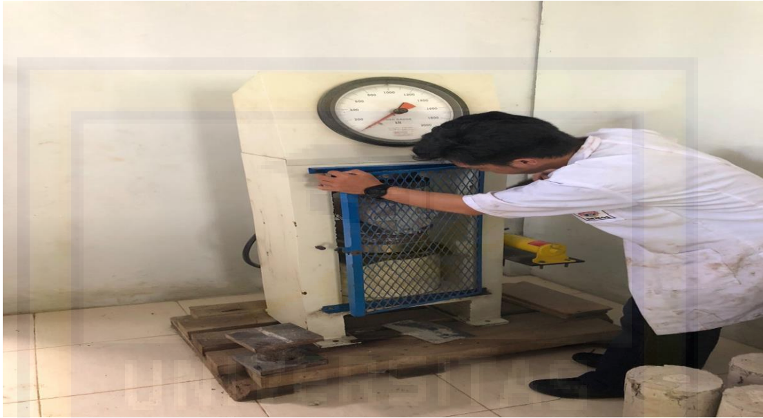
Proses Pengujian Kuat Tarik Belah Beton
