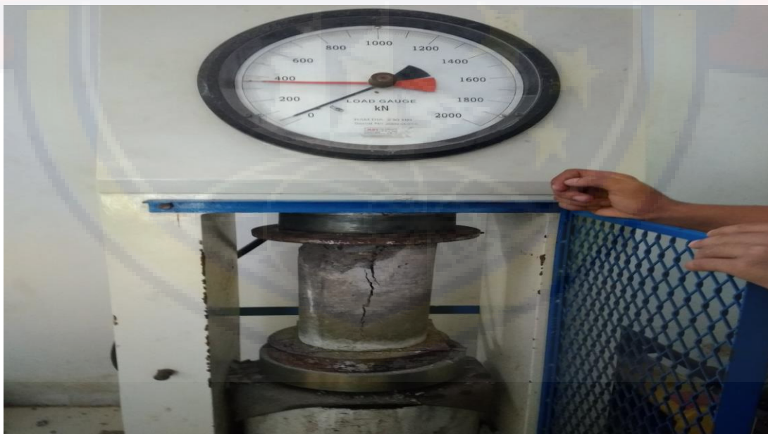
Beton Setelah Di uji Kuat Tekan
