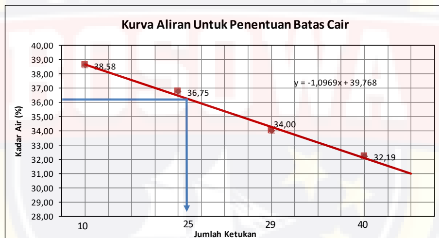
Gambar 4.1 Kurva Aliran Untuk Penentuan Batas Cair
