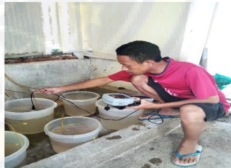
Pengecekan DO Air
