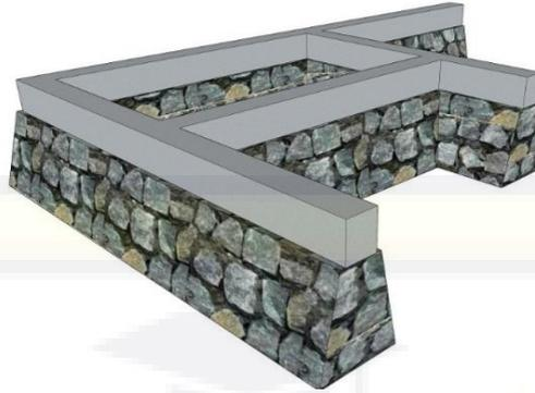
Gambar IV.3 : Pondasi batu kali sebagai *sub struktur* Panti Werdha
