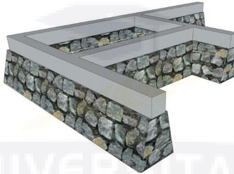
Gambar III.14 : Pondasi batu kali sebagai sub struktur
