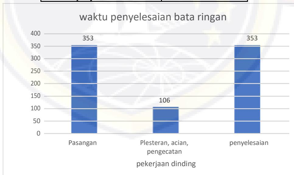
**Gambar 4.12 waktu penyelesaian pekerjaan dinding bata ringan**
