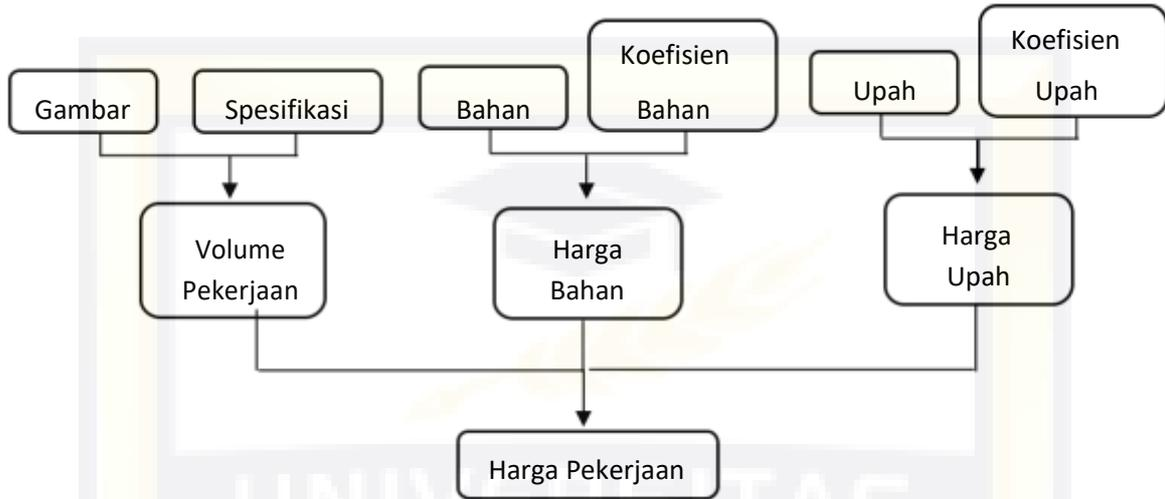
**Gambar 3.13** Analisis Pekerjaan Dinding
