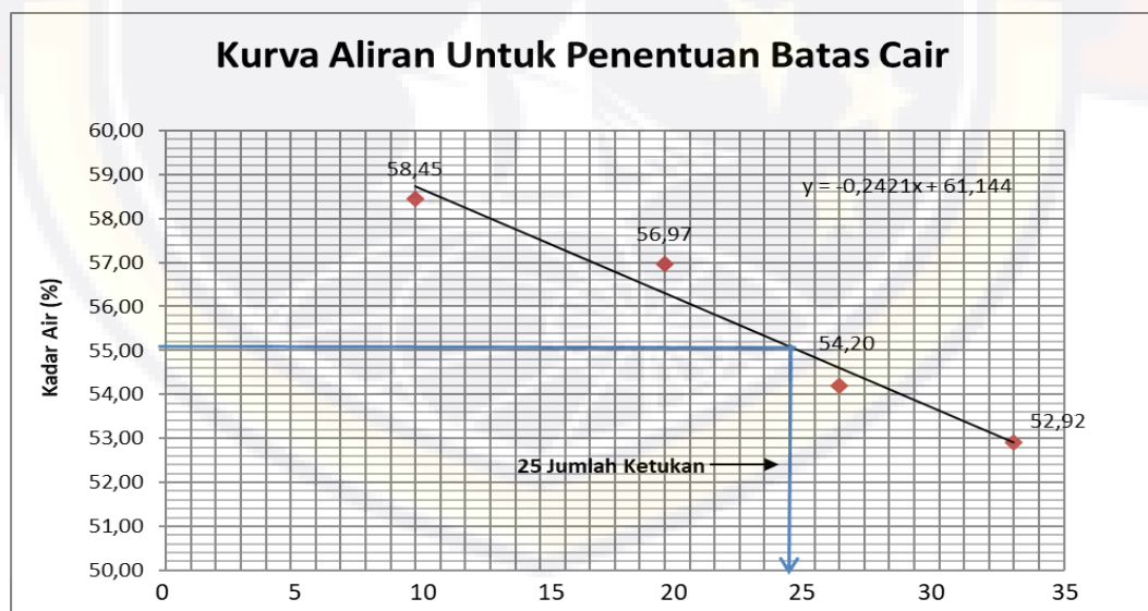
Gambar 4.1 Grafik hasil uji hubungan antara pukulan dengan kadar air
