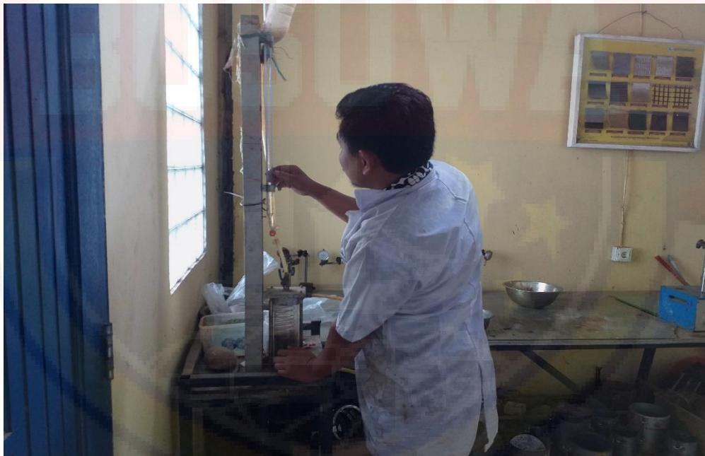
Pengujian Permeabilitas (Rembesan)
