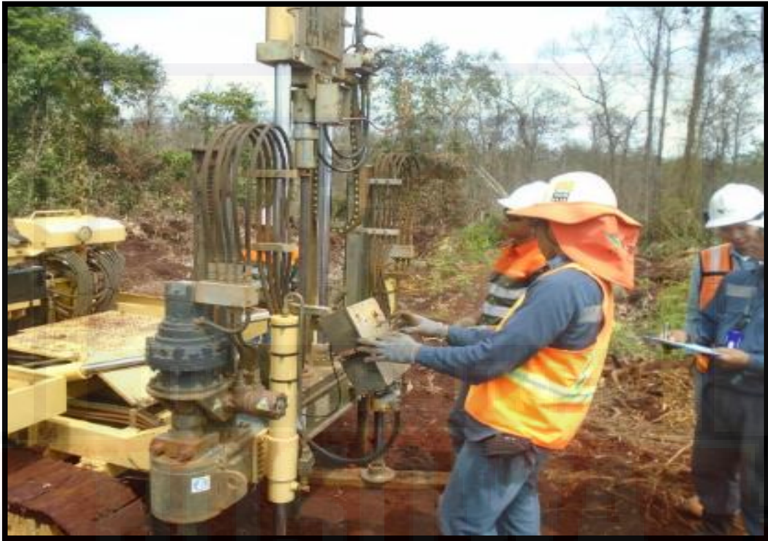
Proses Drilling untuk pengambilan sampel
