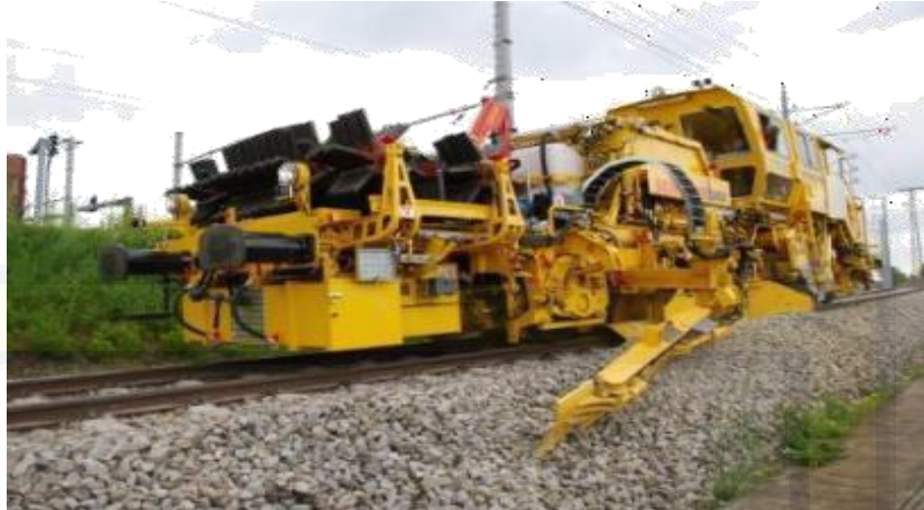
Gambar 3.8 Pengisian Balas Pada Rongga Bantalan
