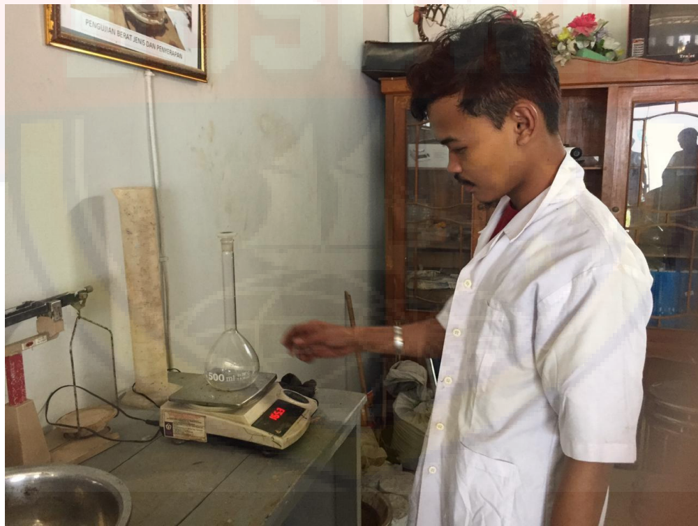
Pengujian Berat Jenis Agregat Halus
