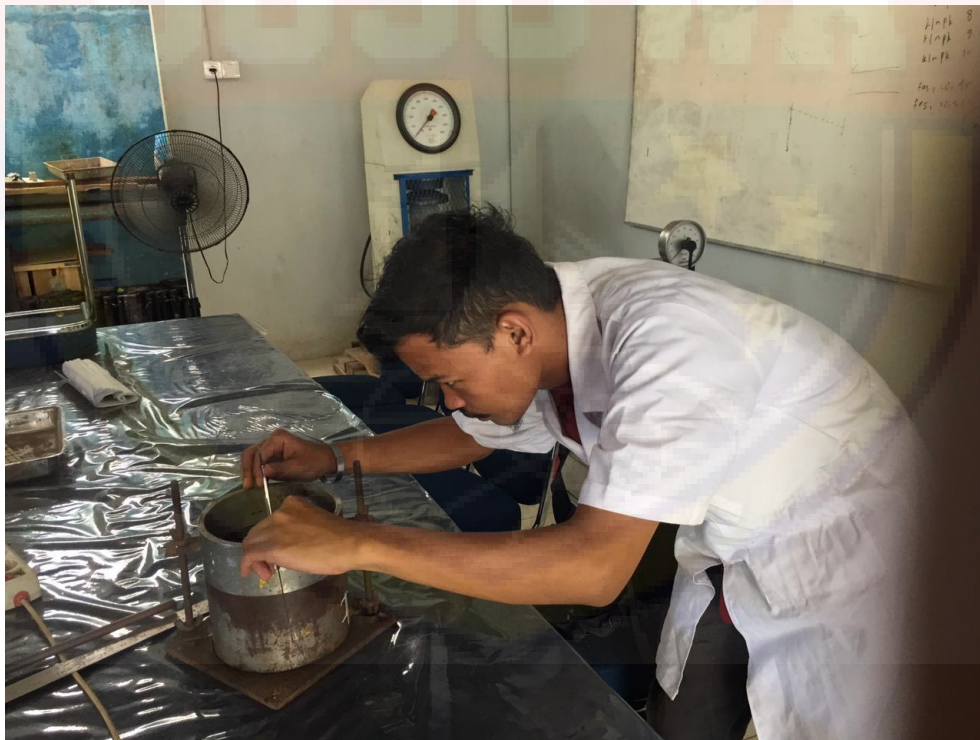
Pengujian Berat Isi Agregat Kasar
