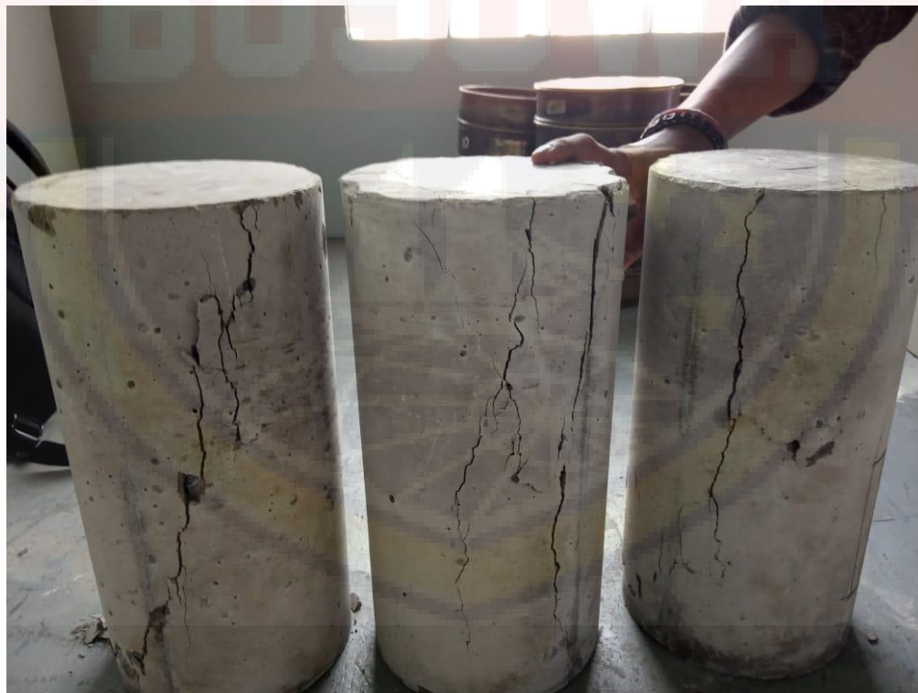
Contoh Keretakan Setelah Pengujian Kuat Tekan
