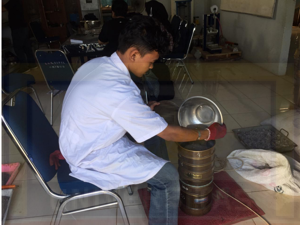
Pengujian Analisa Saringan
