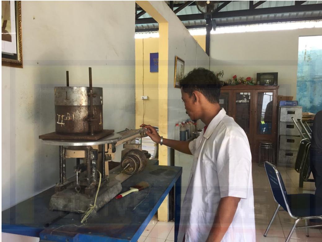
Pengujian Berat Jenis Agregat Kasar
