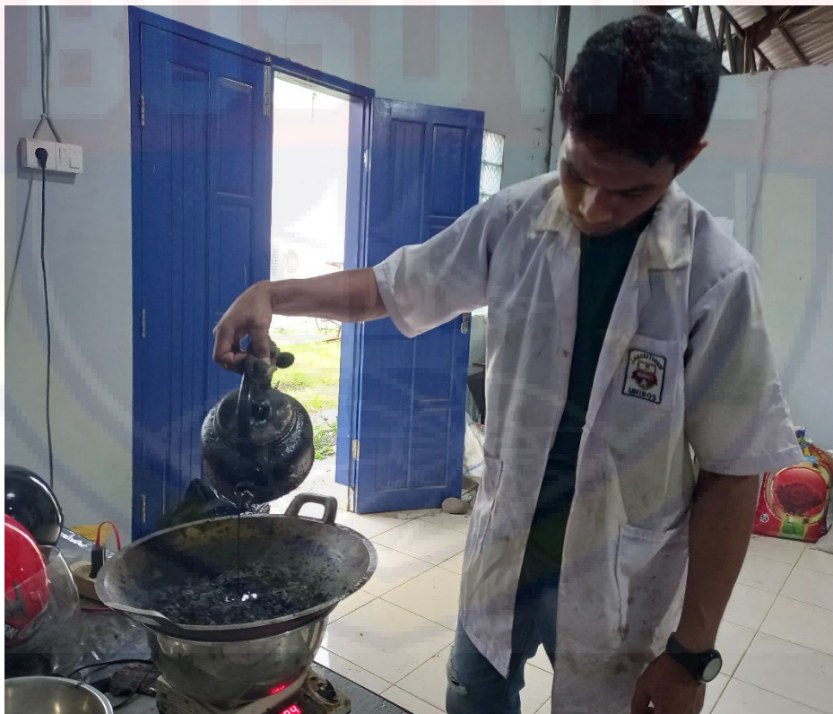
Penambahn aspal Pada material
