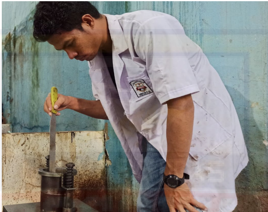
Proses meratakan material dan aspal menggunakan spatula
