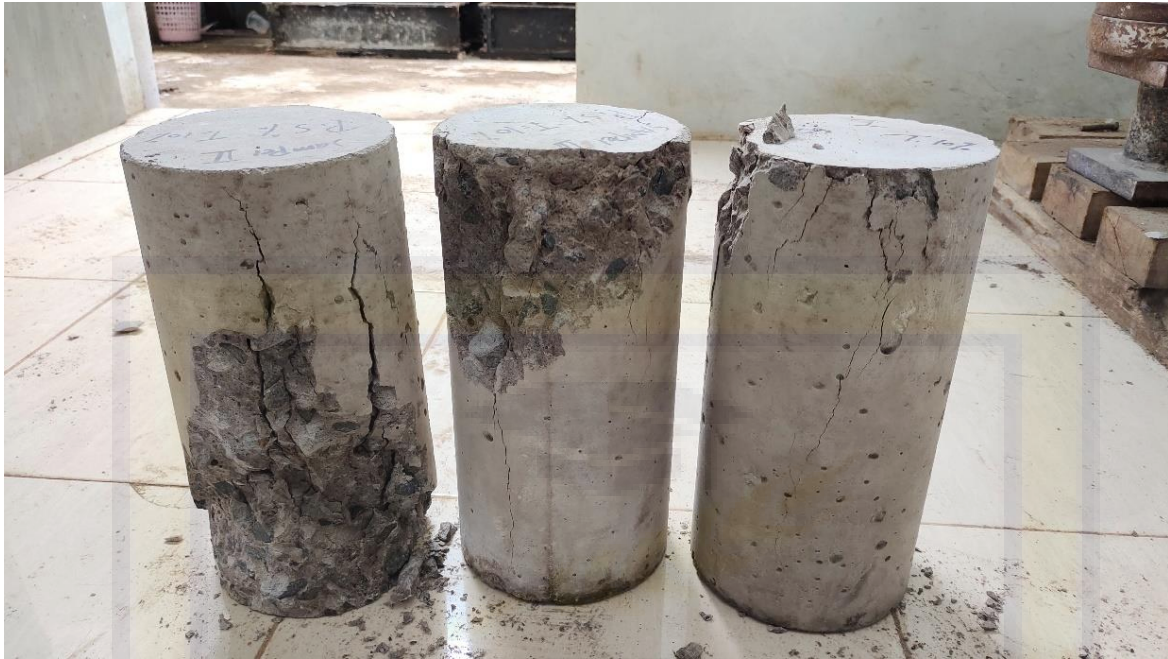
CONTOH KERETAKAN SETELAH PENGUJIAN KUAT TEKAN
