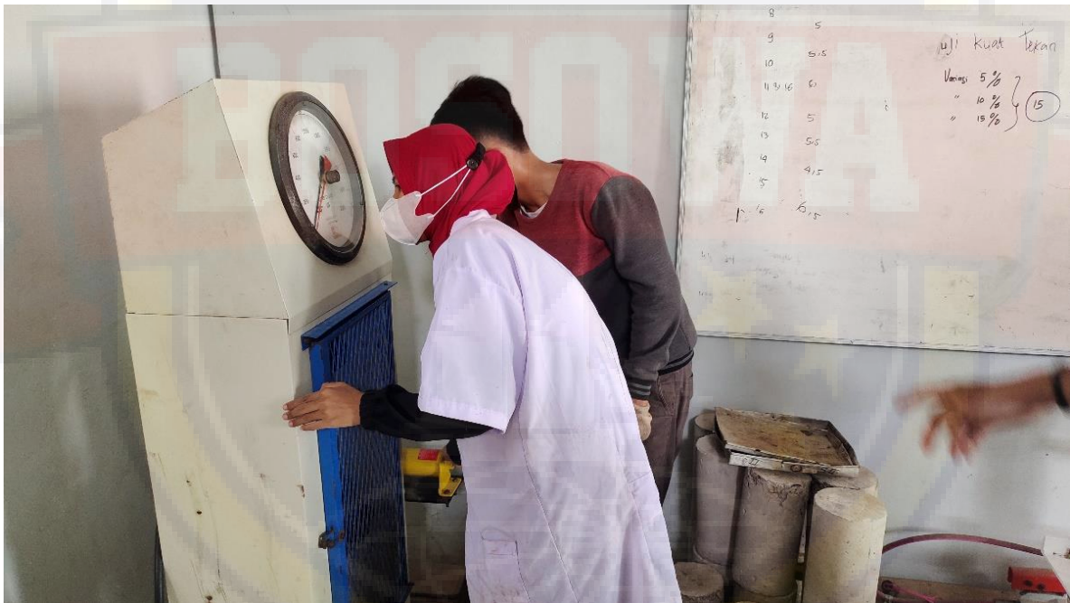
PENGUJIAN KUAT TEKAN BETON
