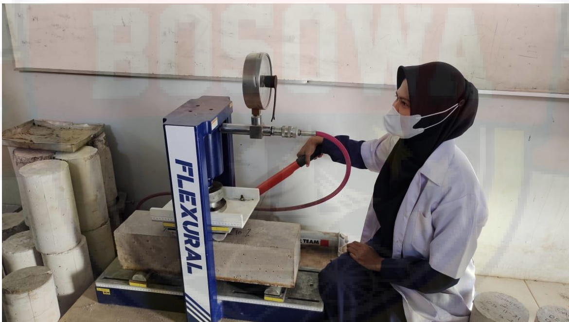
PENGUJIAN KUAT LENTUR BETON
