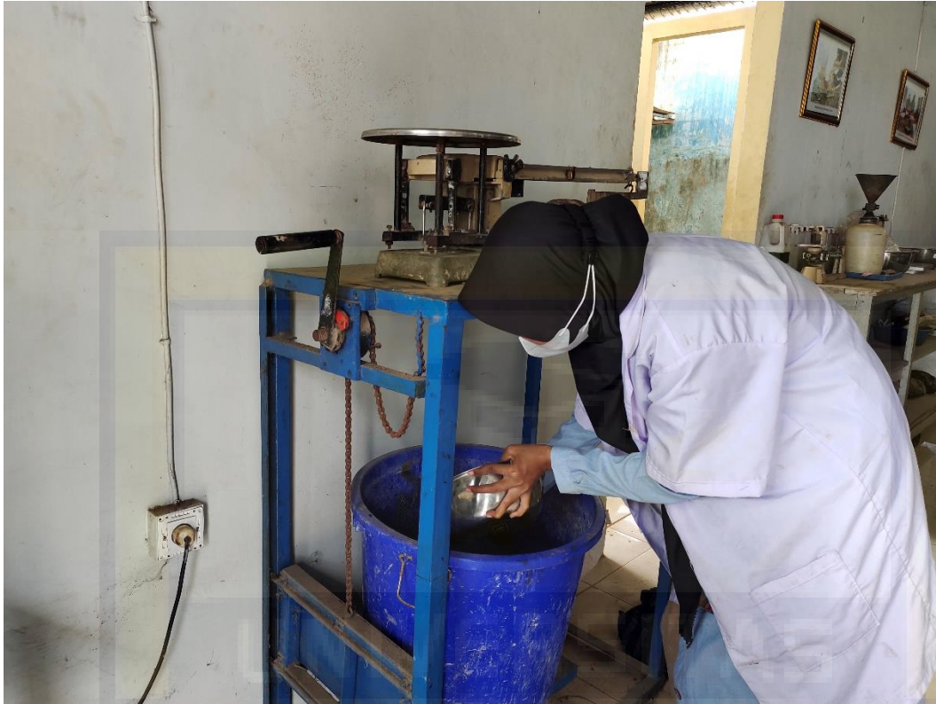
PENGUJIAN BERAT JENIS AGREGAT KASAR
