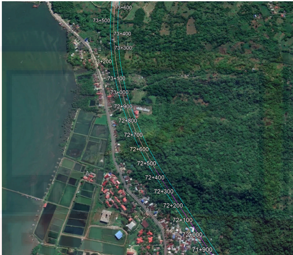
Gambar 4. 1 Alinyemen Horizontal Jalur KA Km. 71+900 s.d 73+600
