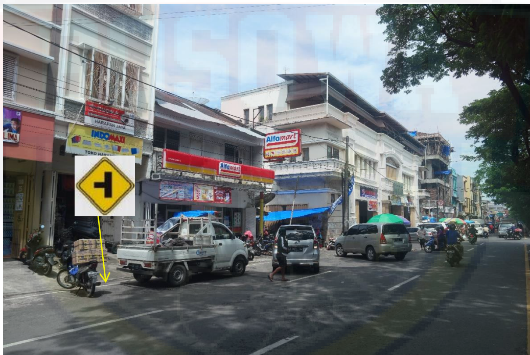
Gambar 4.26 Lokasi simpang tiga Lorong 101 yang membutuhkan pemasangan rambu peringatan simpang tiga sisi kiri. (Opposite) (Sumber : Dokumen Survey)
