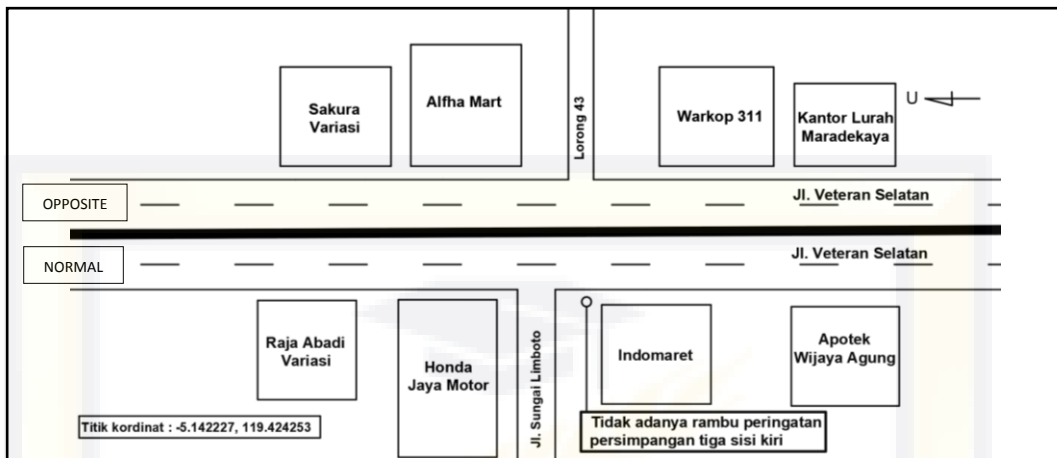
Gambar 4.45 Sketsa model ruas jalan STA 2+900 yang tidak memiliki rambu peringatan simpang tiga sisi kiri. (Sumber : Dokumen pribadi)
