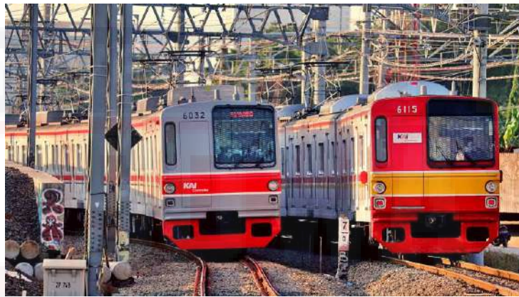
Gambar II.4 Kereta listrik jenis EMU pada jalur komuter Jabodetabek yang ditenagai oleh LAA (Listrik Aliran Atas)
