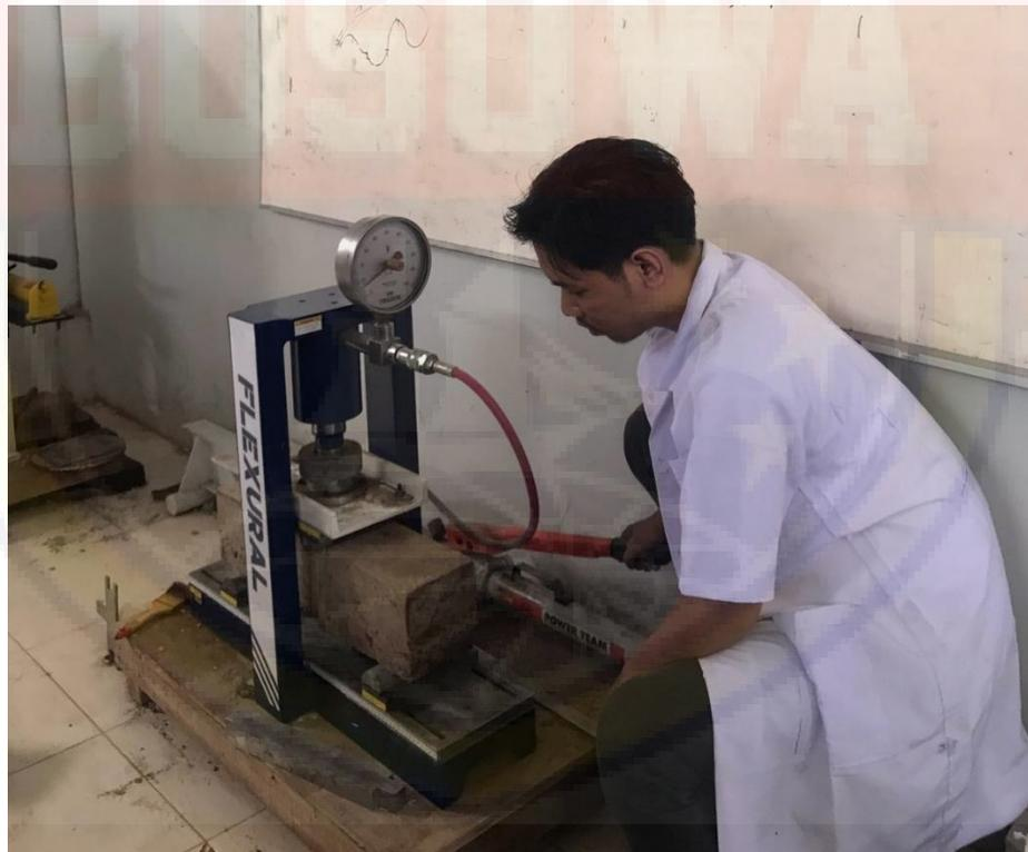
Proses Pengujian Kuat Lentur Beton
