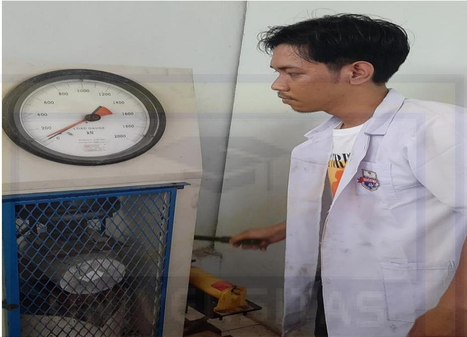
Proses Pengujian Kuat Tarik Beton
