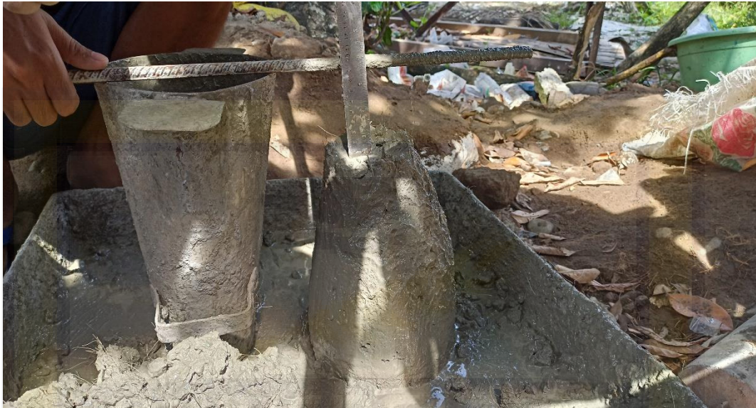
Pengujian Slump Beton Segar
