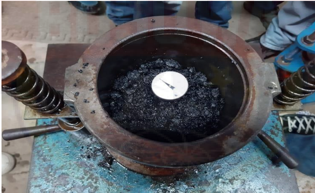
Gambar 1.10. Proses Pengukuran Suhu Sebelum Penumbukan
