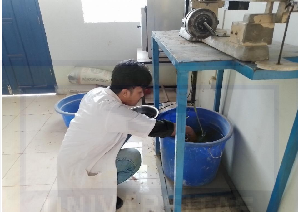
Gambar 1.3. Pengujian BJ Agregat (Berat Dalam Air)
