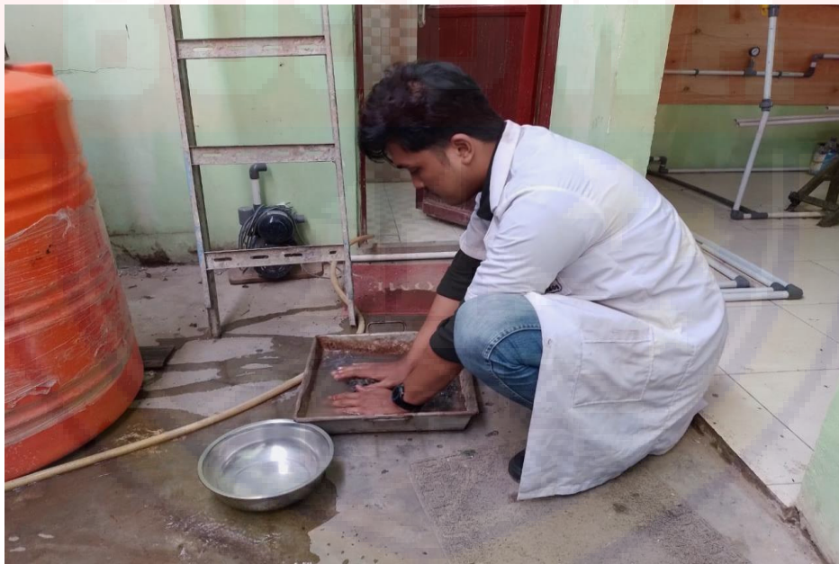
Gambar 1.4. Pengujian Kadar Lumpur Agregat
