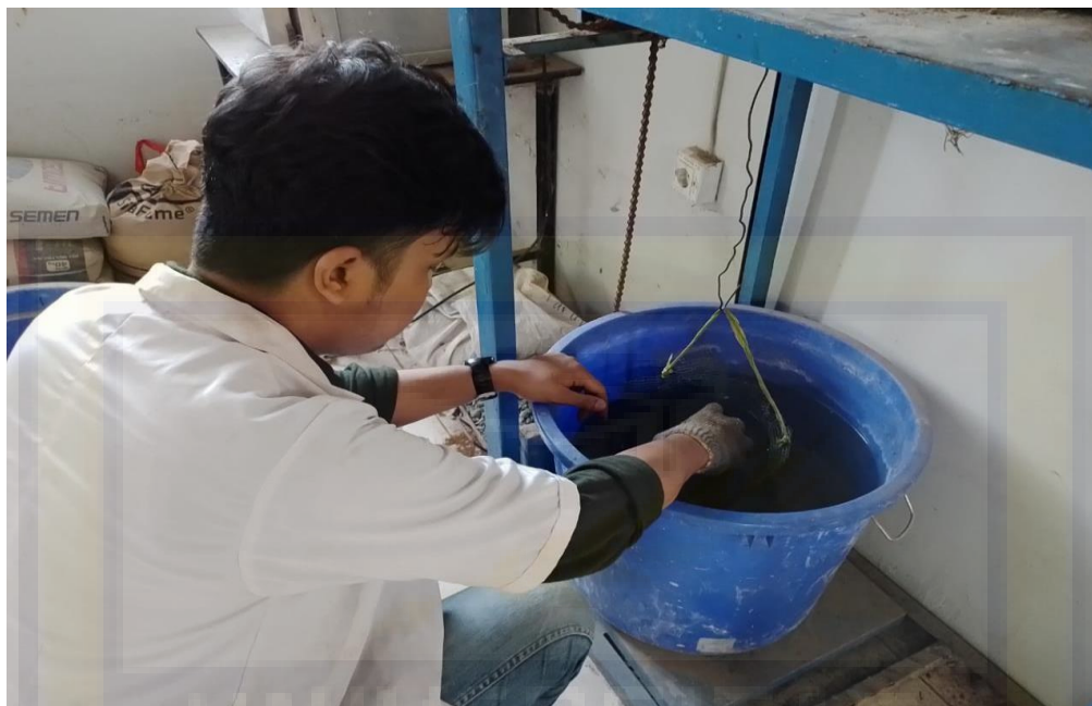
Gambar 1.13. Proses Penimbangan Briket (Dalam Air)
