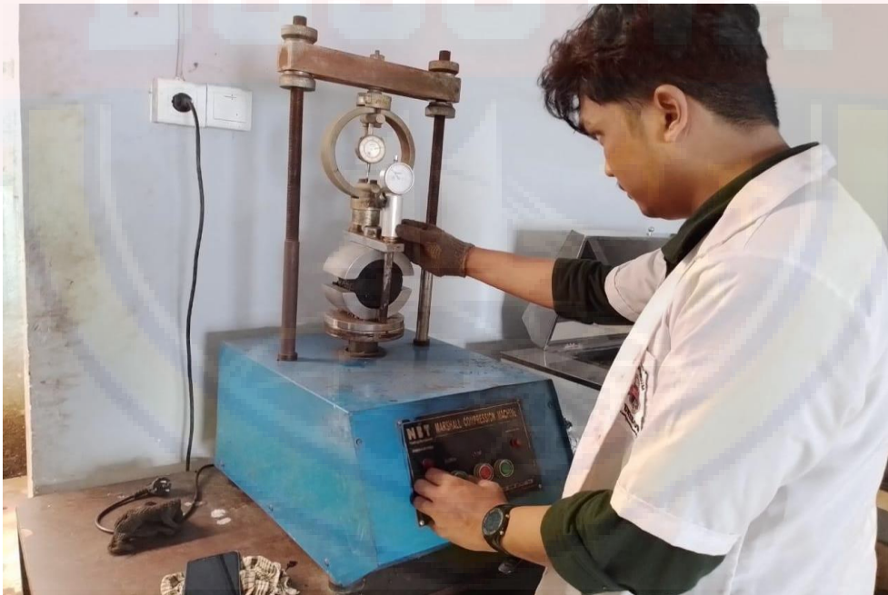
Gambar 1.16. Pengujian Marshall Test
