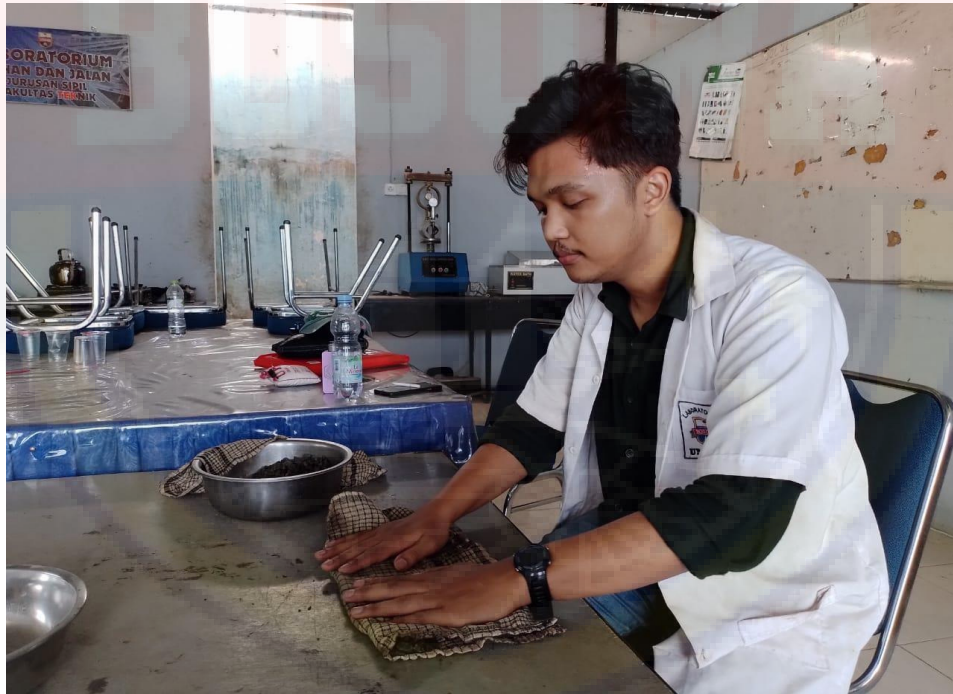
Gambar 1.2 Pengujian Berat Jenis Agregat (SSD)
