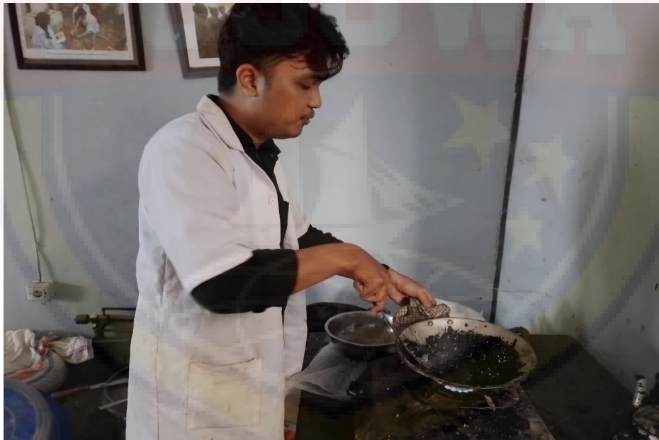
Gambar 1.8. Proses Pencampuran Agregat (Hot Mix)
