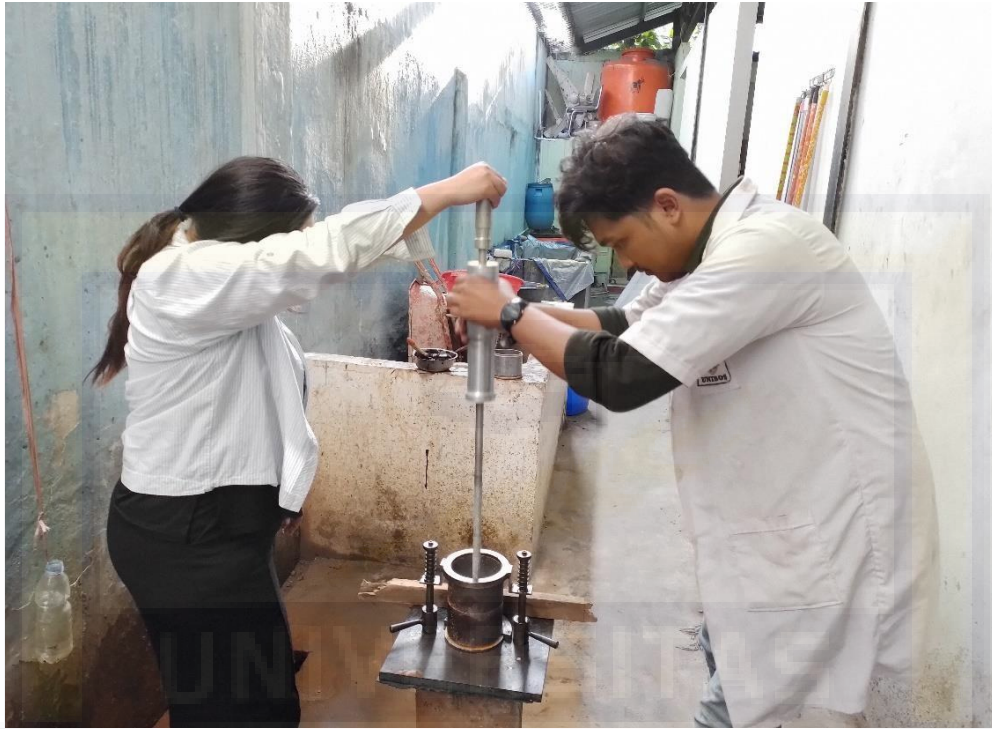
Gambar 1.11. Proses Penumbukan Briket Benda Uji
