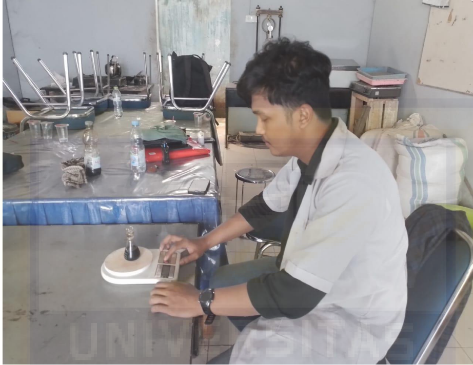
Gambar 1.5. Pengujian Berat Jenis Aspal
