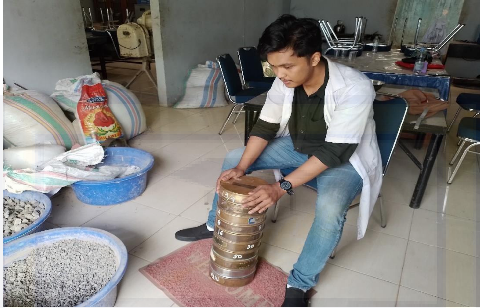
Gambar 1.1 Pengujian Analisa saringan
