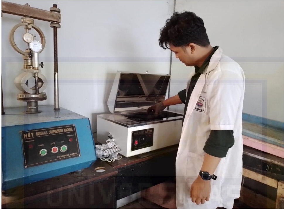
Gambar 1.15. Proses Perendaman Briket Dalam Waterbath
