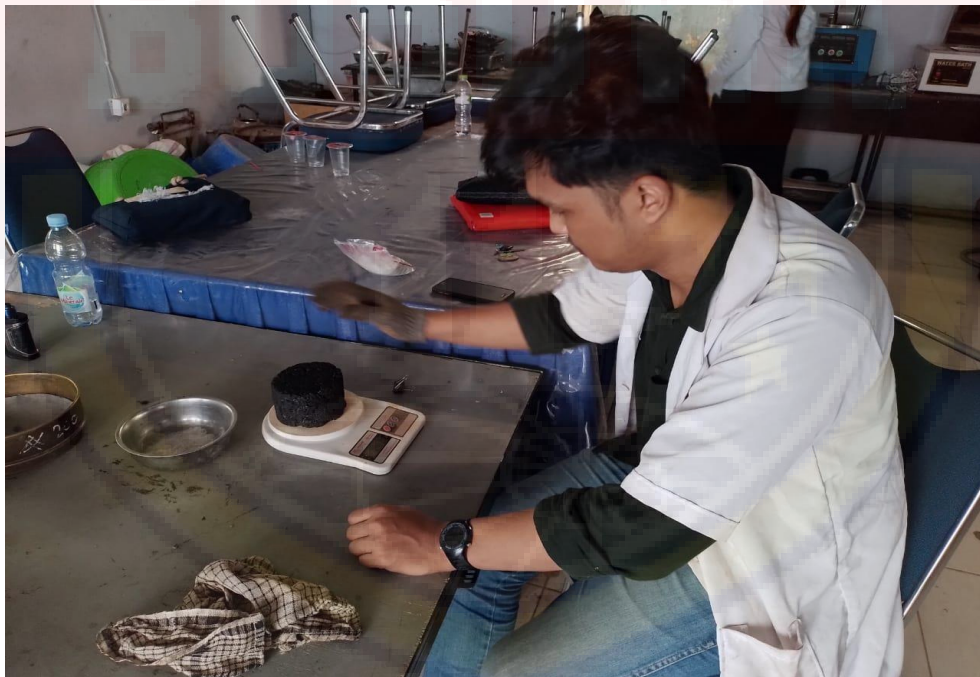
Gambar 1.12. Proses Penimbangan Briket
