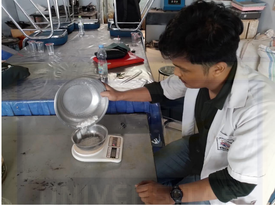
Gambar 1.7. Pengujian Berat Jenis Limbah Gypsum
