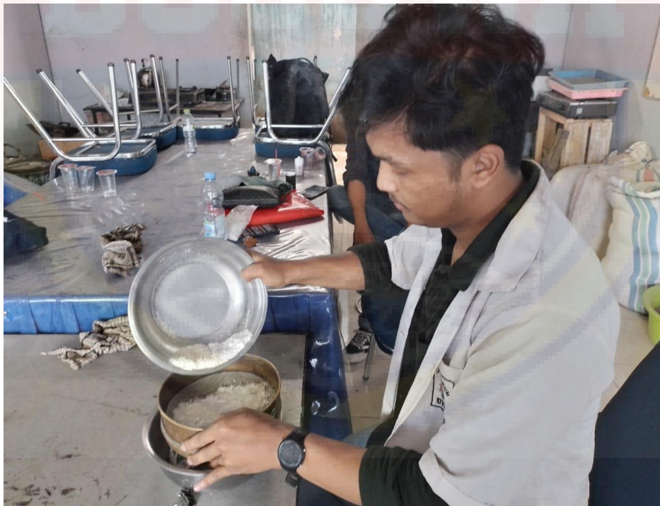
Gambar 1.6. Proses Penyaringan Limbah Gypsum
