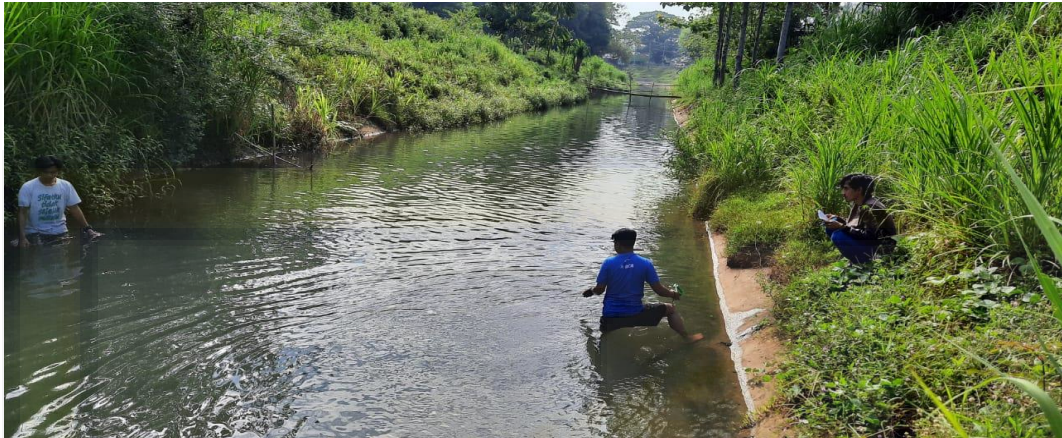
Mengukur Lebar Bawah Saluran Trapesium
