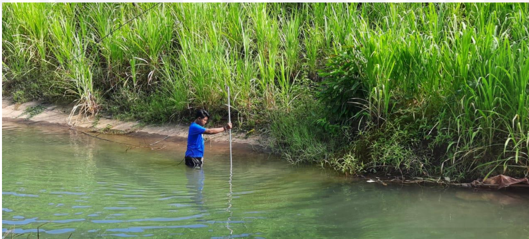
Mengukur Kecepatan Aliran di sisi Kiri saluran dengan Current Meter
