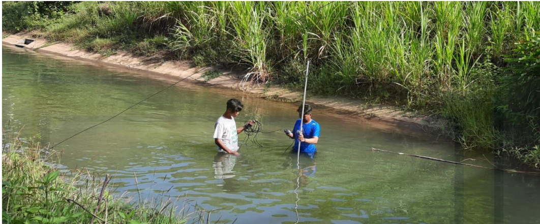
Mengukur Kecepatan Aliran di bagian Tengah saluran dengan Current Meter
