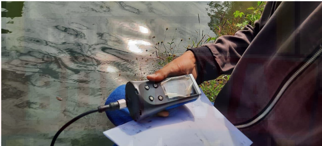
Mengukur Kecepatan Aliran dengan Current Meter
