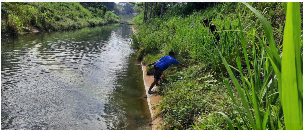
Mengukur Lebar Atas Saluran Trapesium
