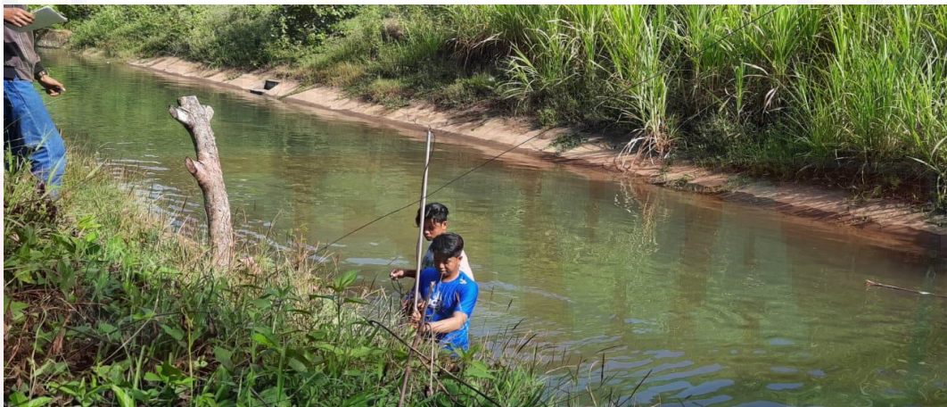
Mengukur Kecepatan Aliran di sisi Kanan saluran dengan Current Meter
