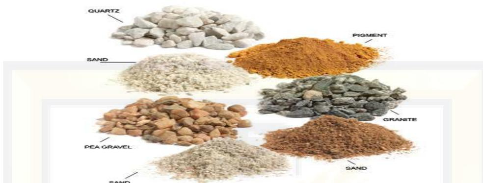
**Gambar 2.1** Agregat kasar dan agregat halus
