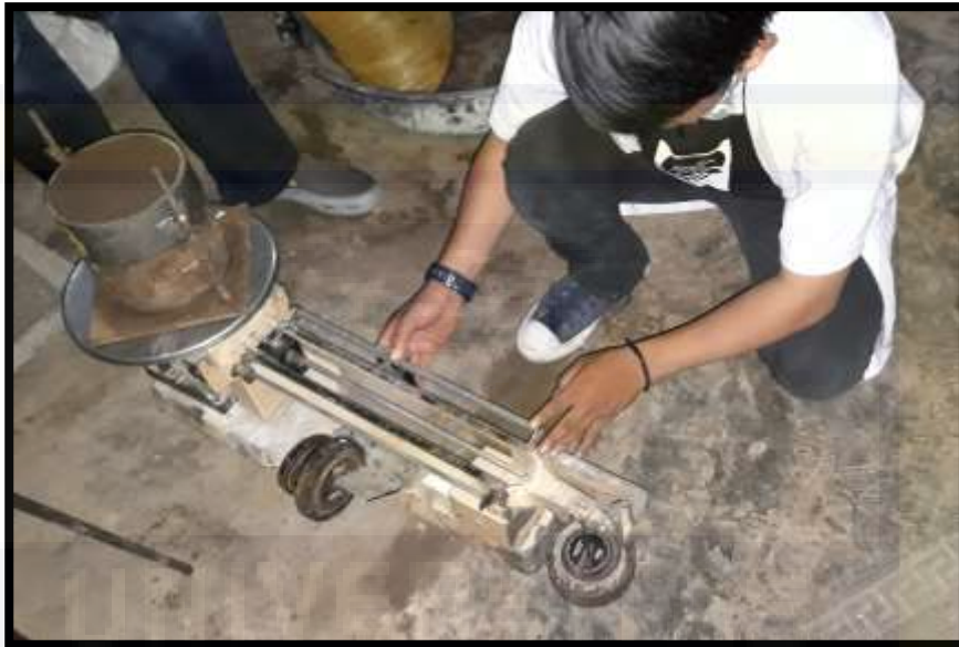
Gambar 5. Penimbangan untuk Pengujian Berat Isi
