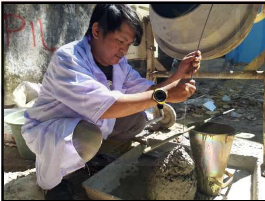
Gambar 12. Pengujian Slump Beton
