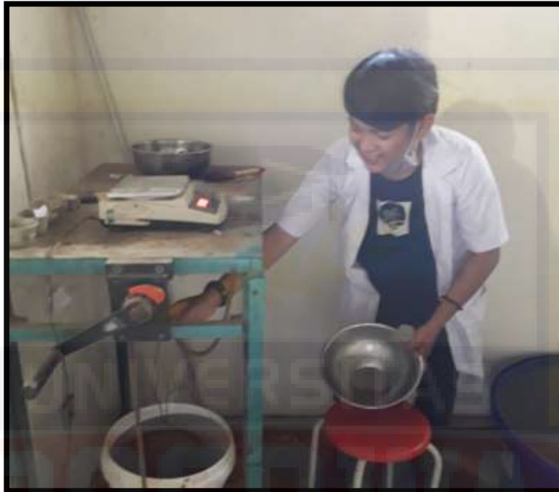
Gambar 7. Penimbangan Material Untuk Berat Isi
