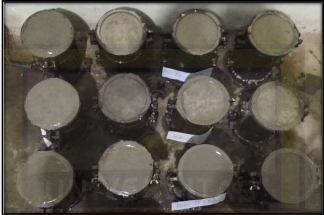
Gambar 15. Beton Segar Hasil Pemasakan
