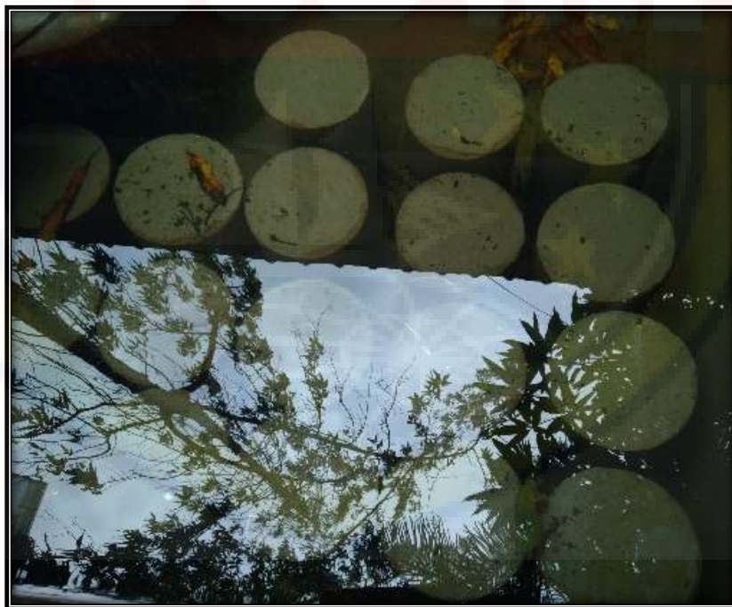
Gambar 16. Proses Perendaman Beton Selama 28 Hari
