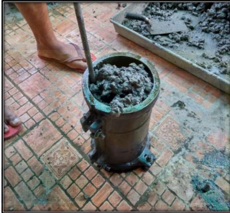
Gambar 13. Pemadatan Beton Dengan Cara Penusukan
