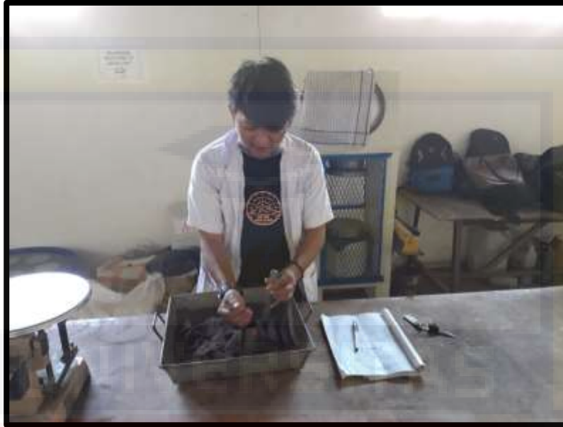
Gambar 3. SSD Agregat Halus Untuk Berat Jenis Agregat Halus
