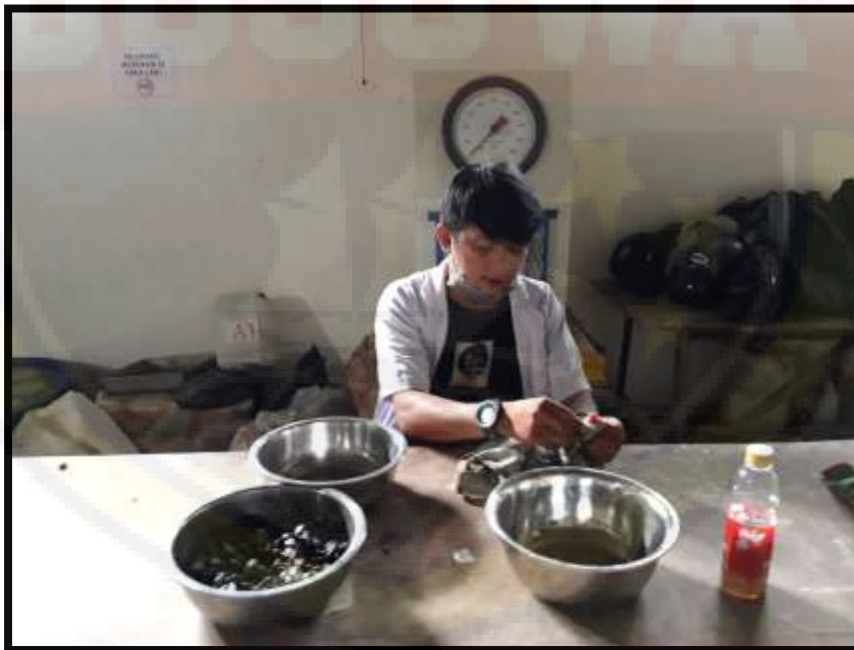
Gambar 4. SSD Agregat Kasar untuk Berat Jenis Agregat Kasar
