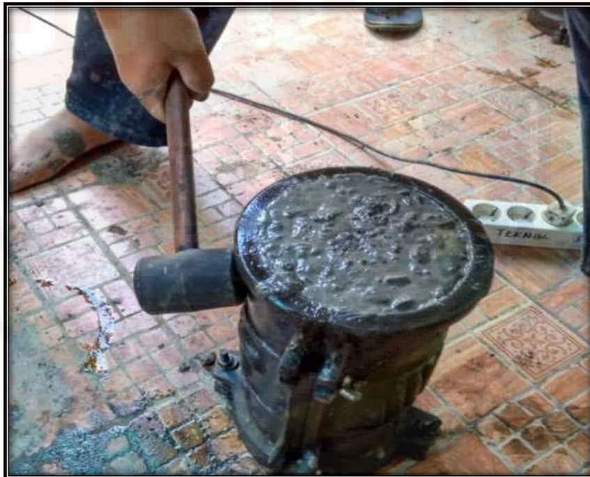
Gambar 14. Pemadatan Dengan Cara Pemukulan Menggunakan Palu Karet
