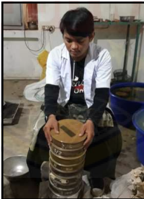
Gambar 2. Pengujian Analisa Saringan
