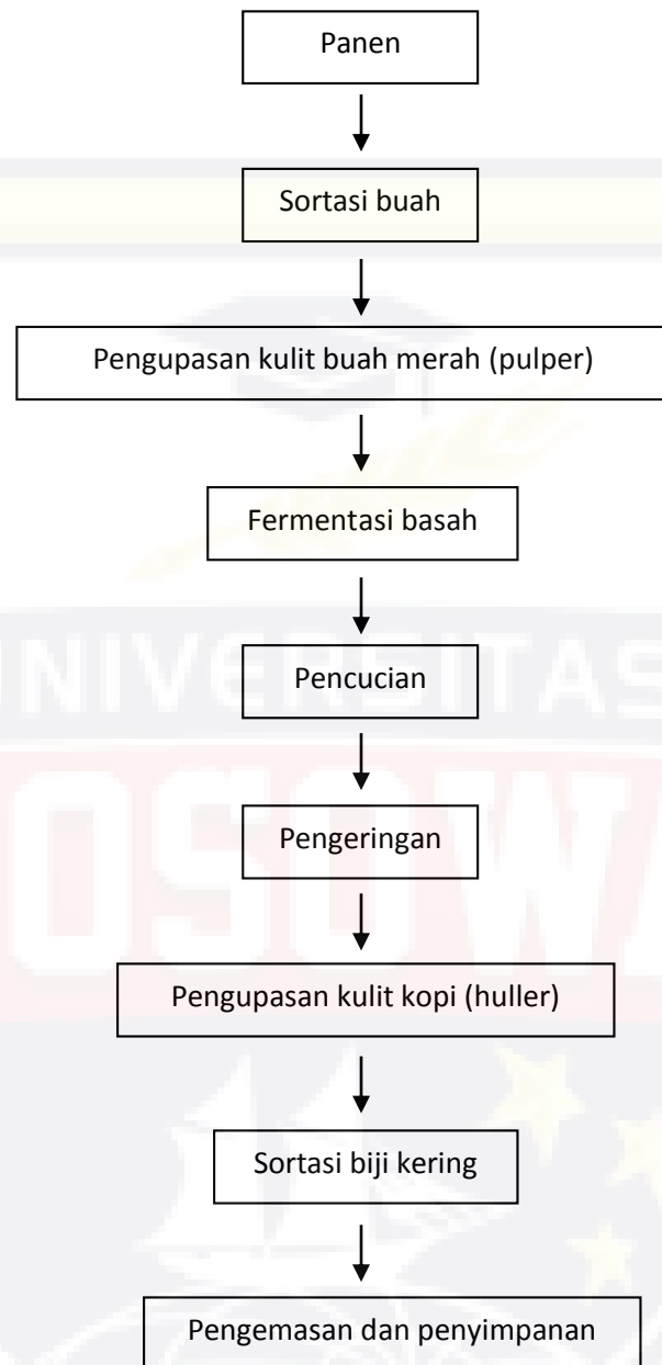
Gambar 3. Diagram alir pengolahan kopi secara basah (wet process) (Ciptadi dan Nasution, 1985).
