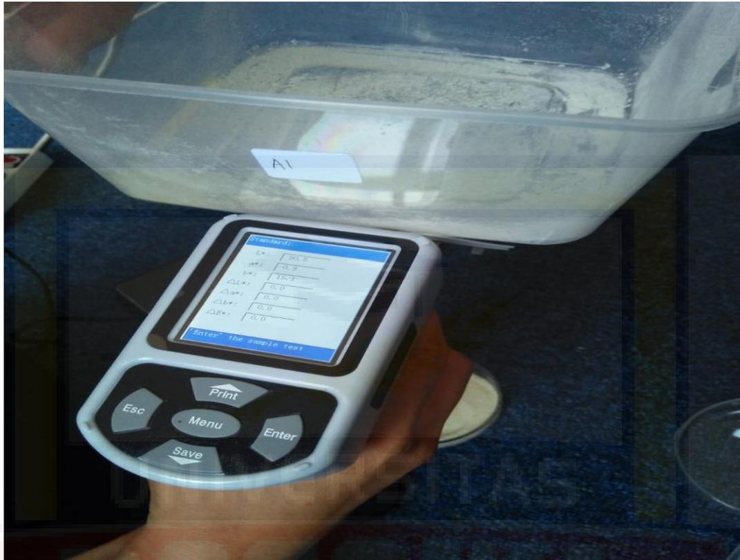
Gambar 7. Uji derajat putih menggunakan Visikometer
