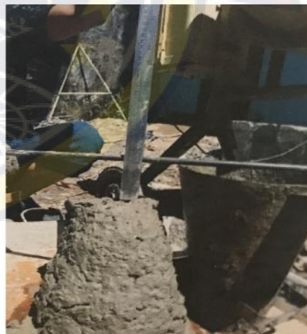
Gambar 11. Pengujian Slump beton
