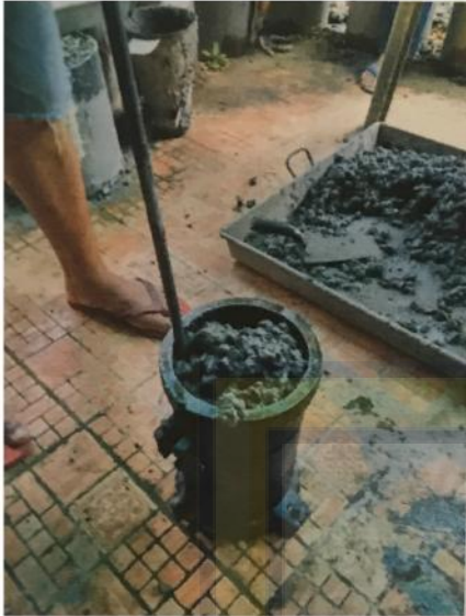
Gambar 12. Pematatan beton dengan cara penusukan
