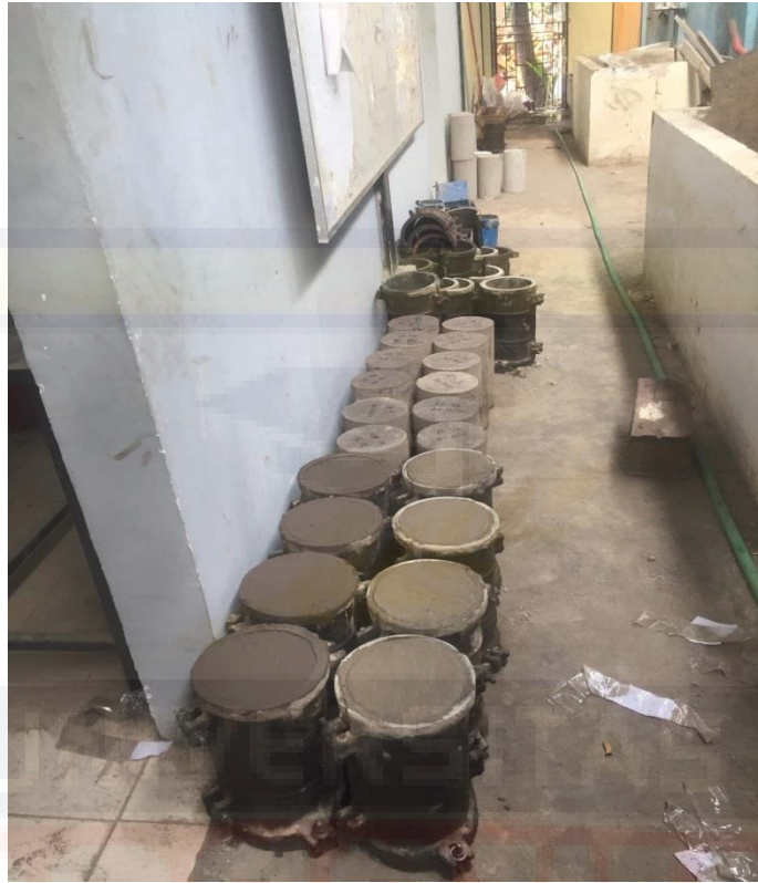
Gambar 7. Beton Segar Hasil Pemadatan
