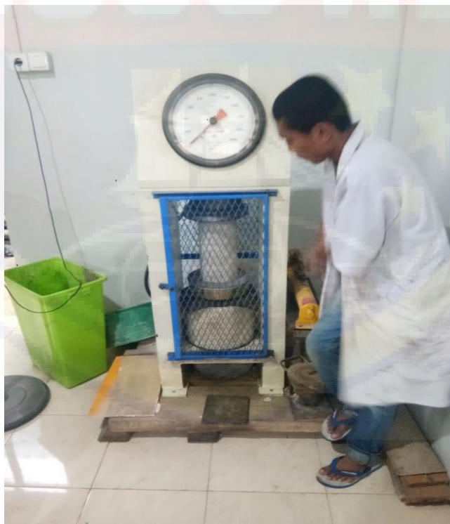
Gambar 12. Proses Uji Kuat Tekan Beton
