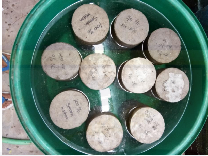
Gambar 9. Perendaman Air Laut Beton Selama 28 Hari
