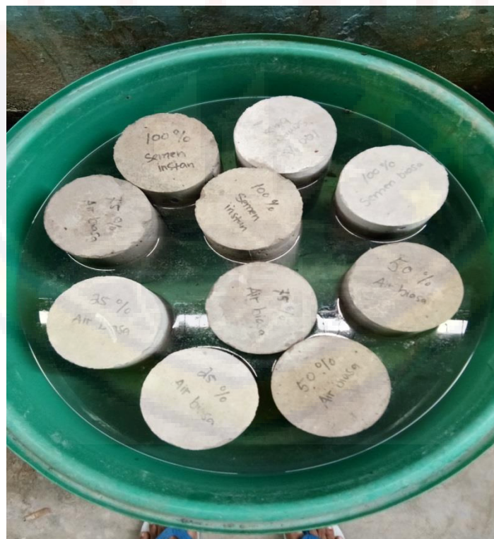
Gambar 8. Perendaman Air Biasa Beton Selama 28 Hari
