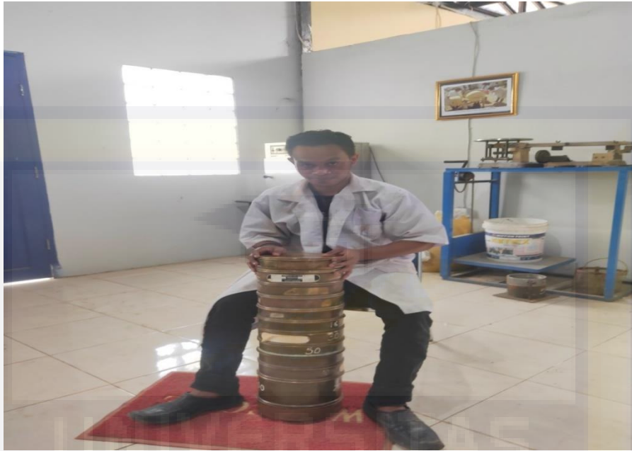
Gambar 3. Pengujian Analisa Saringan
