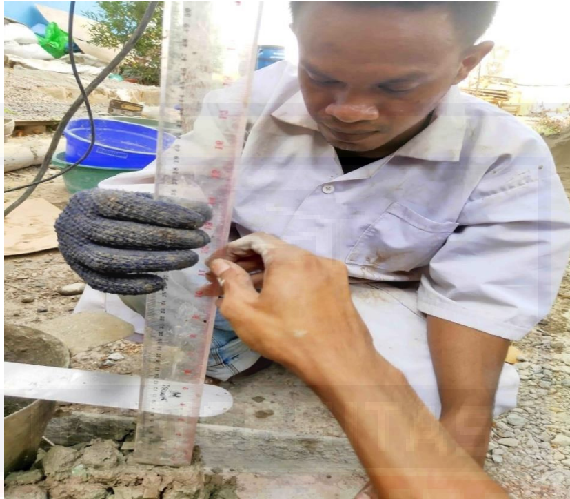
Gambar 11. Hasil Slump Test
