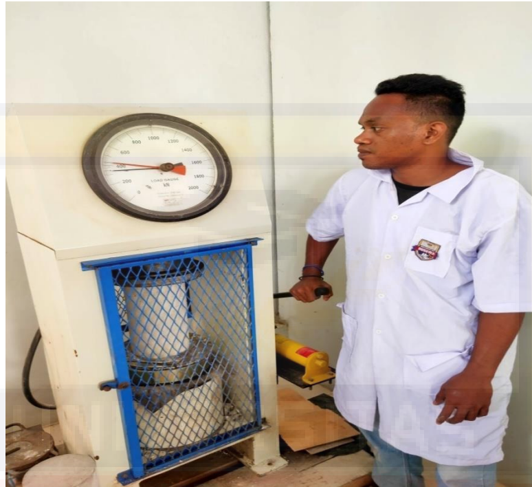
Gambar 13. Pengujian Kuat Tekan Beton
