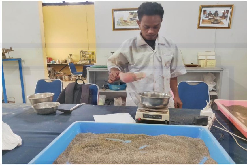
Gambar 5. Penimbangan Agregat Halus
