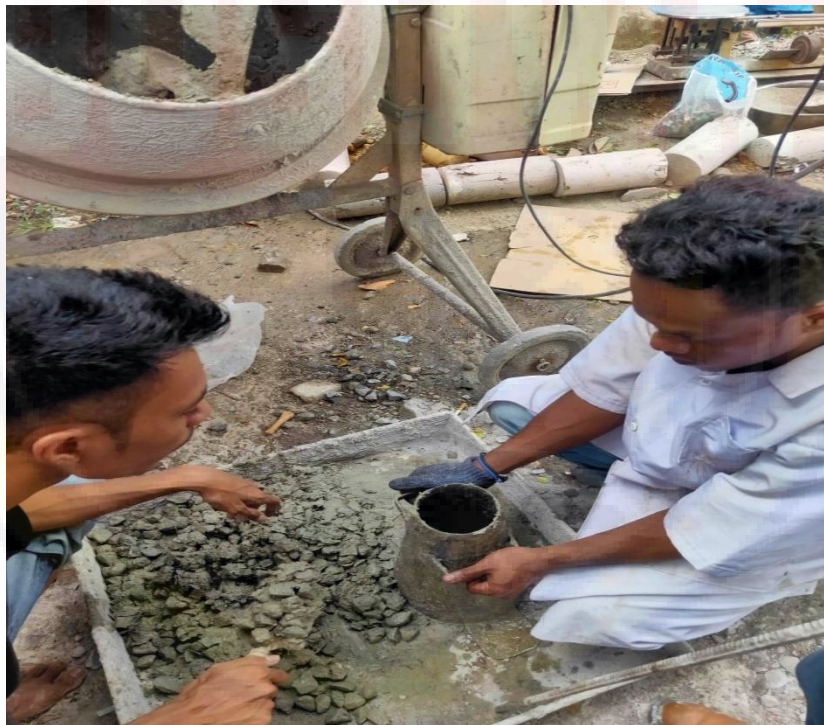
Gambar 10. Pengujian Slump Test
