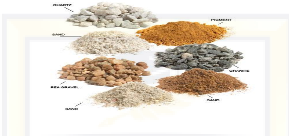
Gambar 2.1. Agregat kasar dan agregat halus
