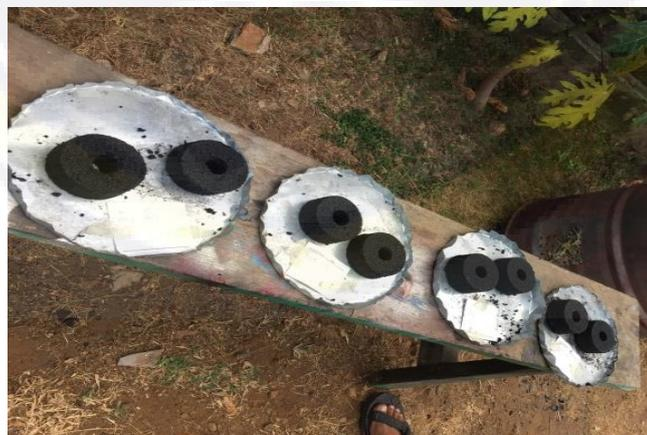
**Gambar C.13:** Briket Dikeringkan Setelah di Pres
