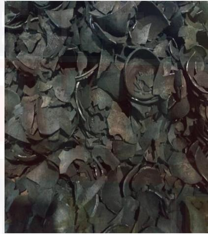
**Gambar C.9:** Arang Tempurung Kelapa Setelah Proses Pembakaran
