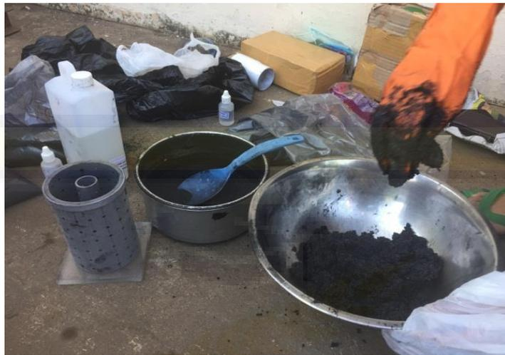
**Gambar C.11:** Proses Pencampuran Arang Tempurung Kelapa dengan Perekat Resin dan Kanji
