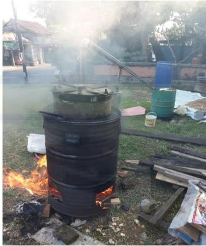
**Gambar C.8:** Proses Pembakaran Tempurung Kelapa dengan Metode Pirolisis
