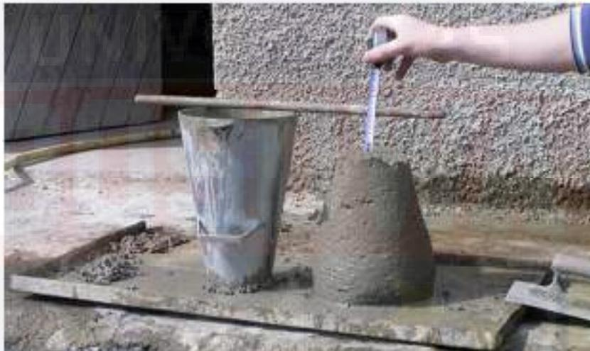
Gambar 2.6 Uji Slump Test
