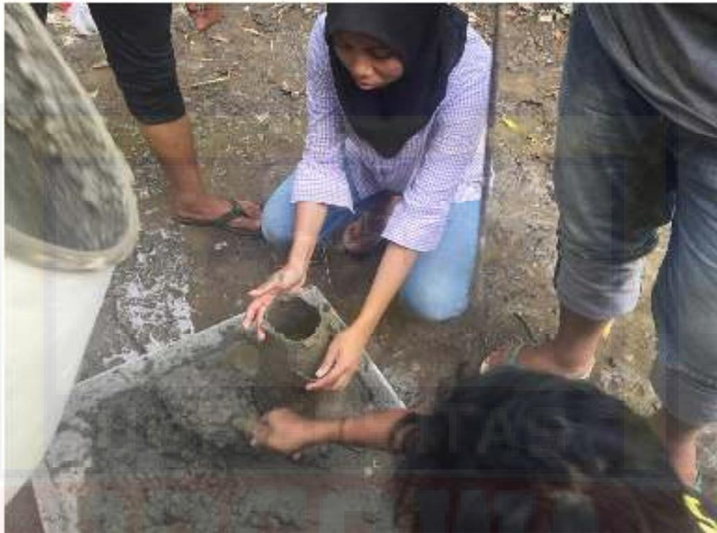
**PROSES PENGUJIAN SLUMP TEST**
